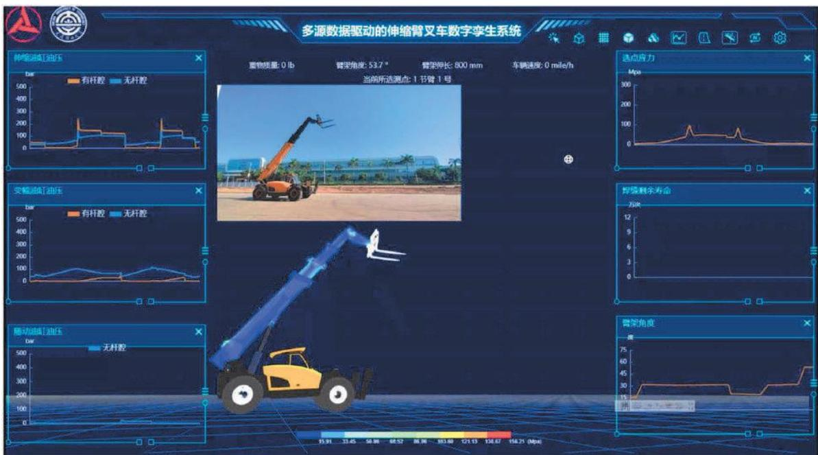
Fig. 24: Visualizzazione del digital twin in scala di un sollevatore telescopico usando WebGL
