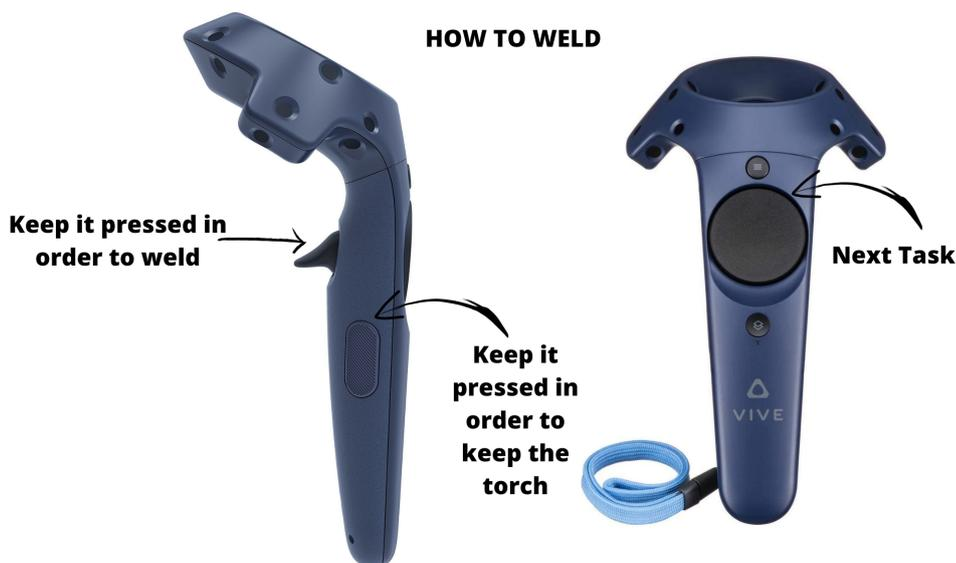
Figura 4.9: Tasti necessari per la saldatura
