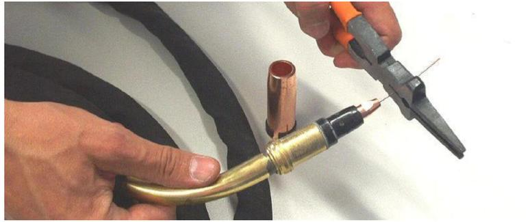
**Figura 2.10:** Taglio del filo di saldatura
