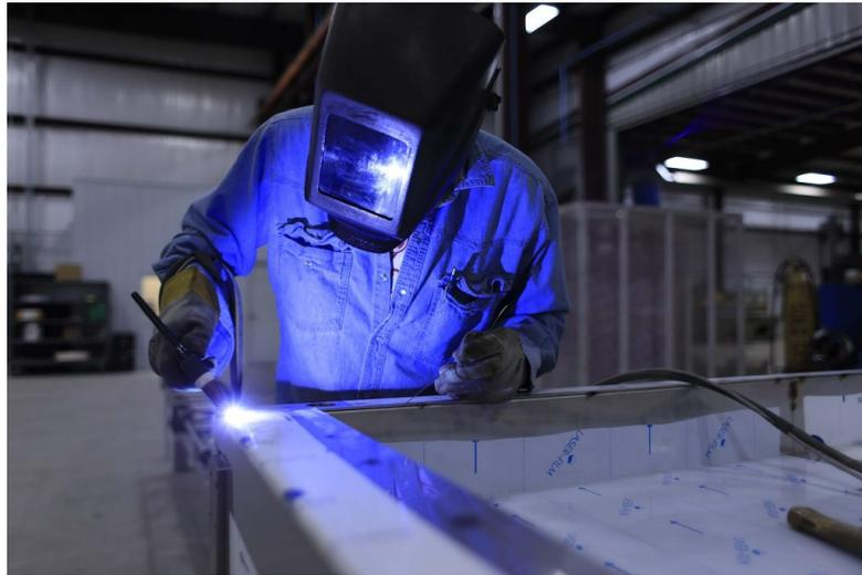
**Figura 2.3:** Esempio di saldatura autogena
