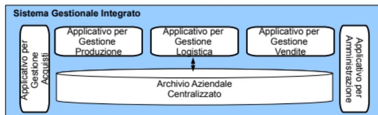
Figura 1.2: Architettura di un Sistema Informativo Integrato
