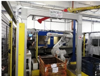
Figura 54.: Robot in fase di carico del grezzo sul Buffer. (Fonte: Foto personale)
