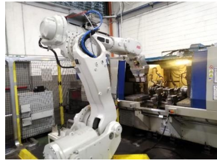
Figura 55.: Robot in fase di prelievo del semilavorato dalla macchina. (Fonte: Foto personale)
