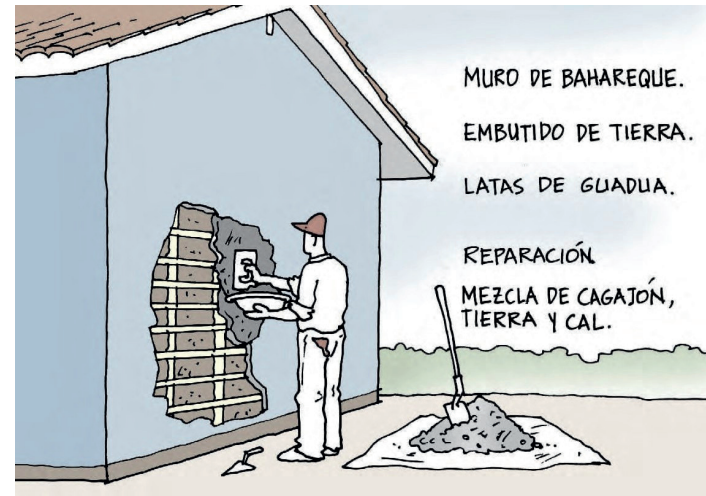
Figure 135: Repair of revoque (plaster) and empañetado (finish coat) (Asociación Colombiana de Ingeniería Sísmica, 2002)
