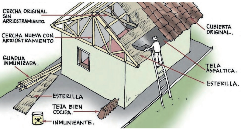
Figure 139: Improvement of partial collapse of the roof. (Asociación Colombiana de Ingeniería Sísmica, 2002)
