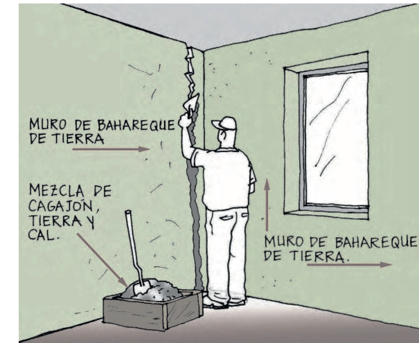
Figure 136: Repair of detachment between walls (Asociación Colombiana de Ingeniería Sísmica, 2002)
