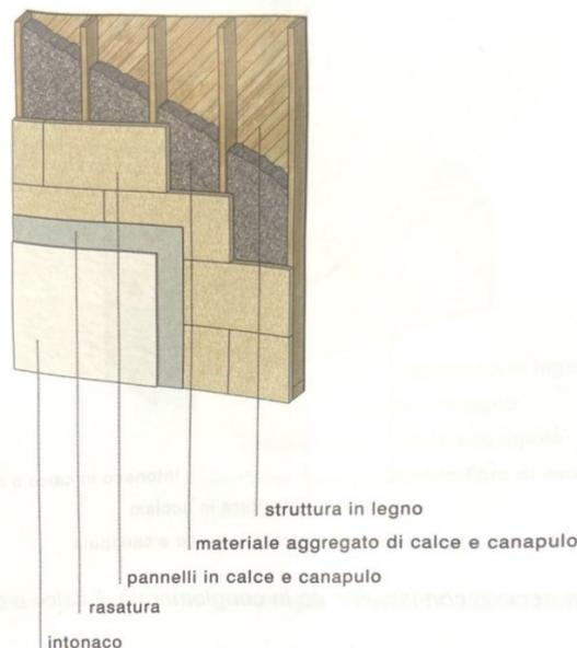
**Figura 3.16:** esempio applicazione struttura in legno con isolamento in conglomerato e pannelli di calce-canapa<sup>139</sup>
