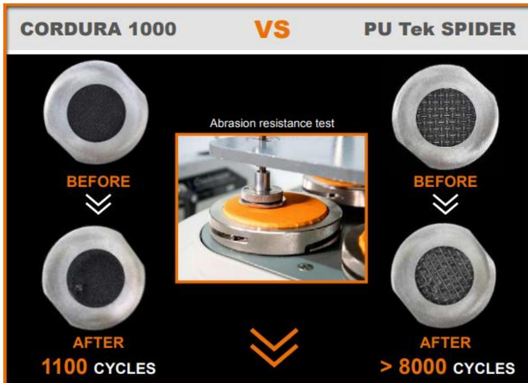
Figura 2.4: EN 388 prova di resistenza all'abrasione con carta vetrata
