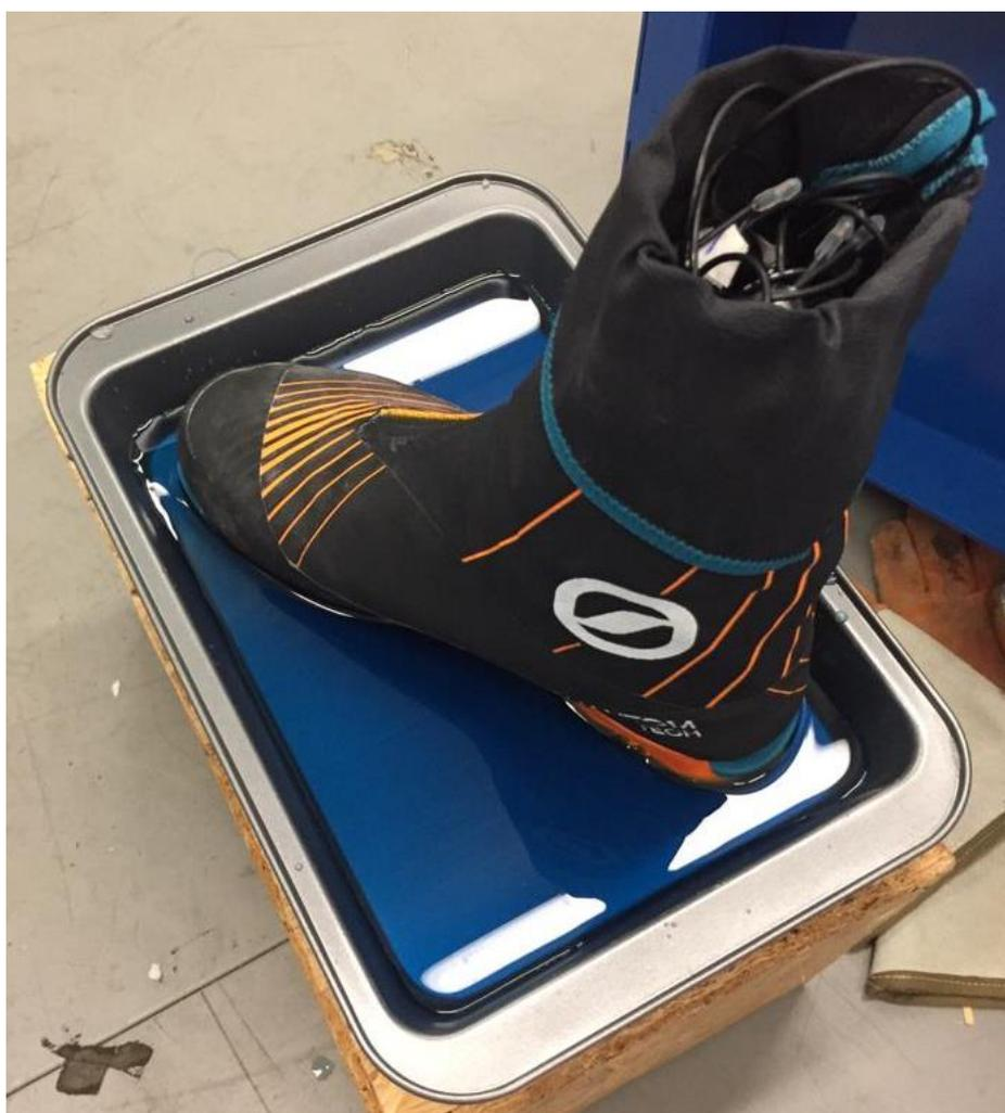
*Figura 5.4: suola dello scarpone immersa nella soluzione di acqua e glicole*
