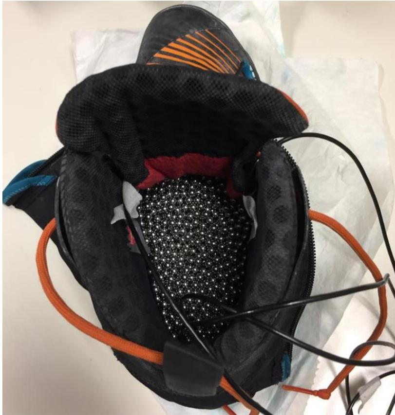
*Figura 3.3: Scarpone con all'interno le sferette in acciaio inox*
