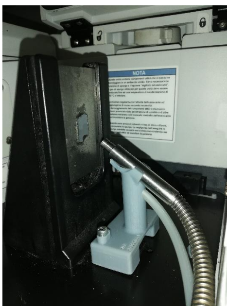
Figura 2.7: La lampada Hamamatsu LC8 montata all'interno dello spettrometro Thermo Scientific™ Nicolet™ iS50 FTIR
