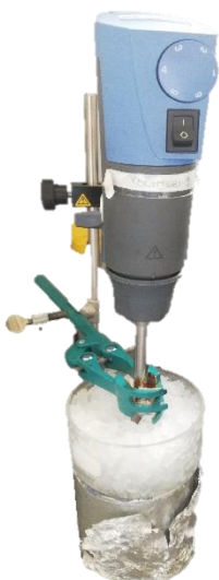
Figura 2.4: Dispersione dei MWCNTs all'UltraTurrax
