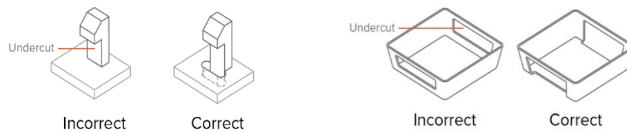
Figura 15 - Due esempi di chiusure
