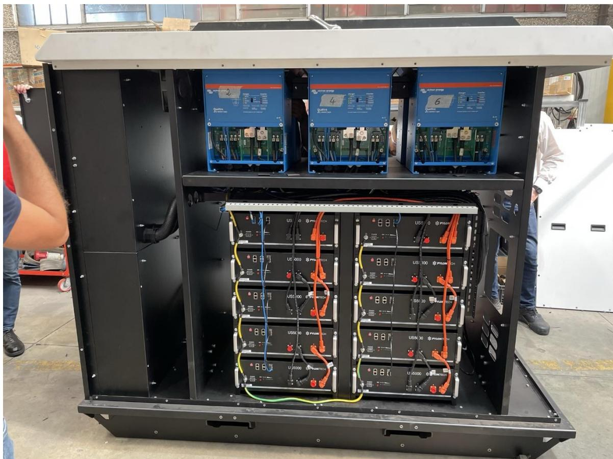
Figura 47- visione laterale prototipo BESS LX
