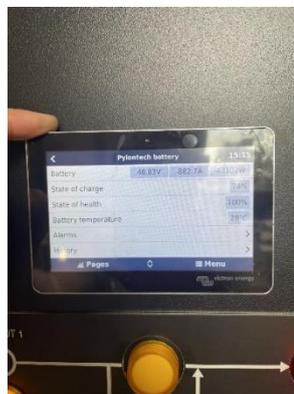
Figura 39- schermo LCD di controllo
