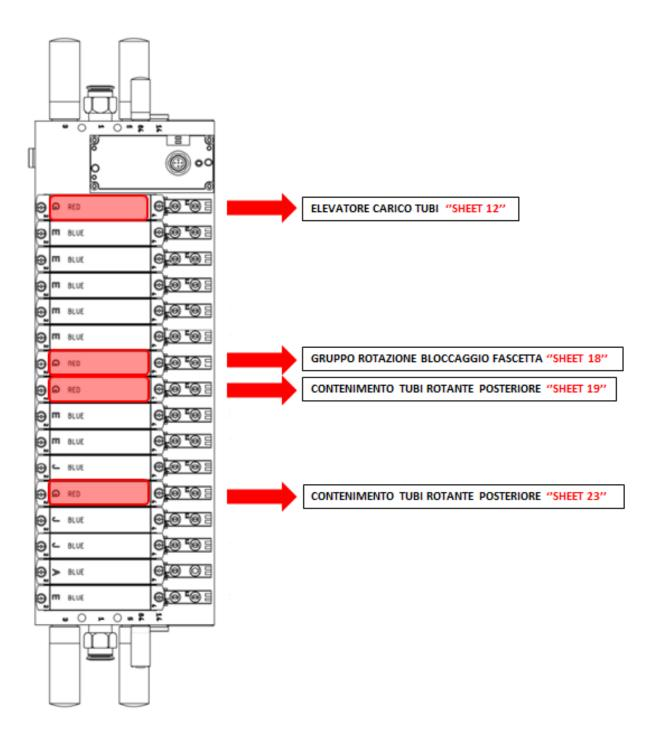
Figure 23. Valve island schematiozation
