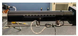
Figura 2.13: I finecorsa installati sull'attuatore.
