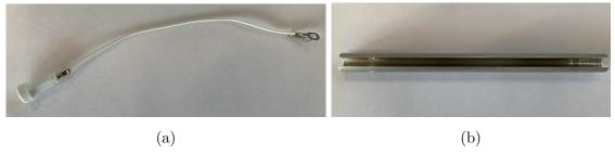
Figura 2.22: Nella figura (a) è mostrato il cavo per la misurazione della corrente e nella figura (b) lo strumento per inserire il cavo nella tasca.
