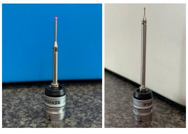
(a) Sonda 1x10 con estensione di 10 mm.
