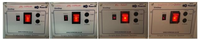
Figura 3.4: I segnali di raggiungimento del finecorsa.
