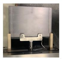
Figura 3.21: Collegamento centrato tra la slitta UP/LEFT/RIGHT e il relativo attuatore.
