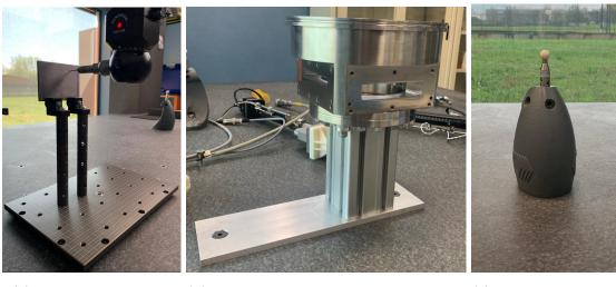
(a) I fissaggi modulari. (b) Il supporto utilizzato per sollevare e (c) La sfera per la bloccare la camera. qualifica.
