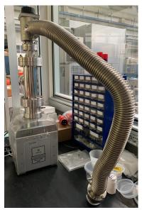
Figura 3.12: La pompa turbomolecolare per la realizzazione dell'alto vuoto.
