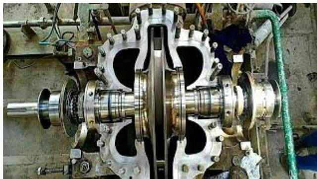
Figura 1.8: sito [1], esempio di pompa centrifuga con rotore nel mezzo
