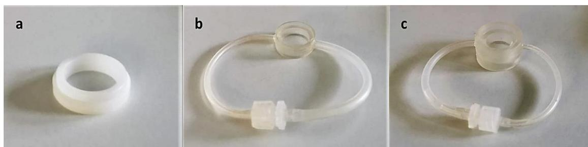
*Figura 17: a) holder, b) camera basale e c) camera apicale del bioreattore LB2.*
