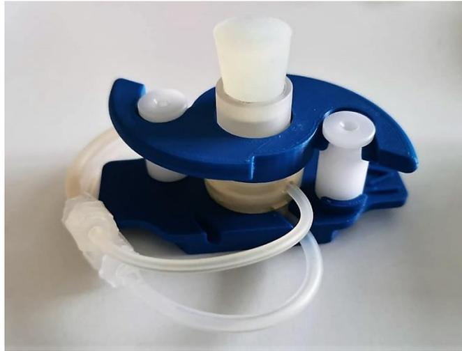
*Figura 19: Bioreattore LB2 chiuso superiormente con la porta d'accesso montata al posto del vetrino superiore, con il suo tappo siliconico.*
