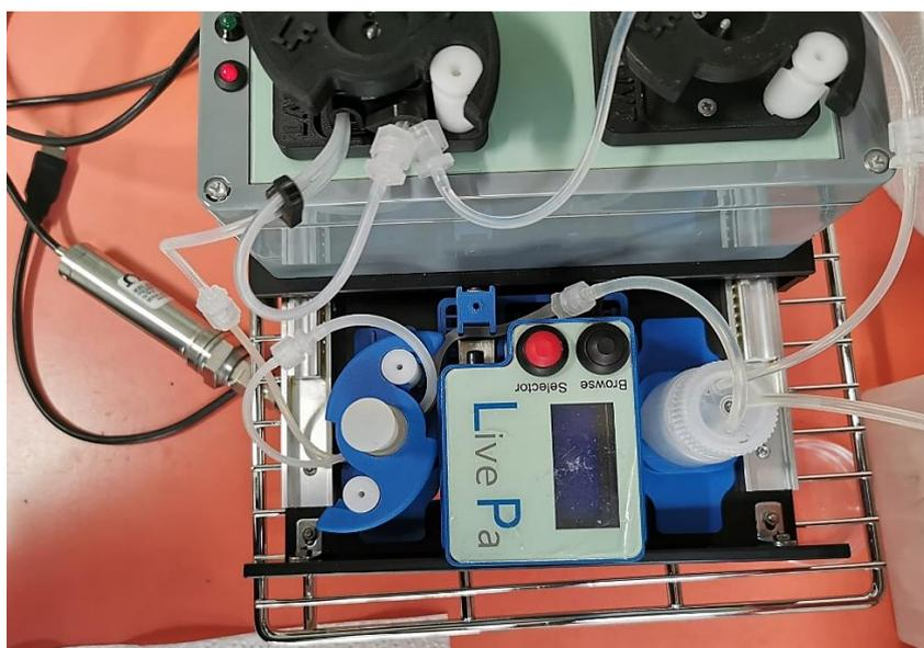
*Figura 24: Configurazione del circuito con bioreattore, reservoir e modulo LivePa alloggiati nell'apposito cassetto della pompa peristaltica.*
