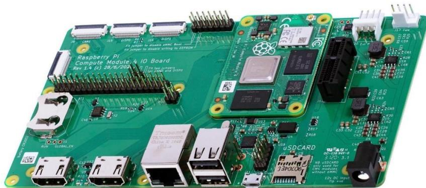
Figura 7: Raspberry PI CM4 inserito nella I/O module board, sulla destra vi è la porta PCIx1
