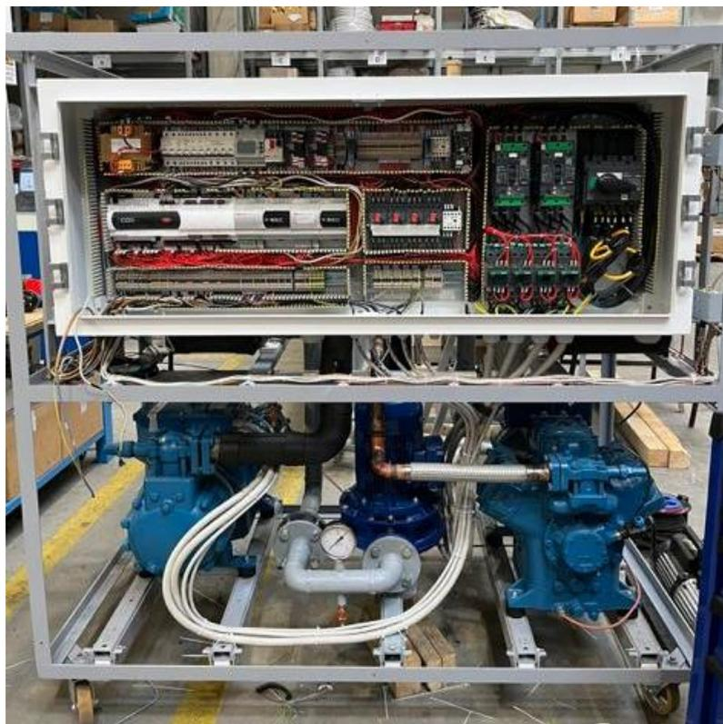
*Figura 1.48 – B. Foto del quadro elettrico già montato ad esclusione delle due ante*
