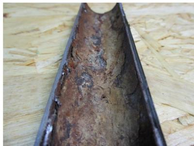
Figura 5.7. Sezione di una tubazione soggetta a corrosione [37]
