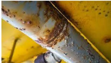
Figura 5.9. Tubazione soggetta a corrosione galvanica [39]
