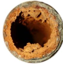
Figura 5.6. Calcare all'interno delle tubazioni [36]
