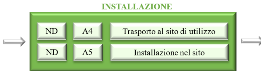
Figura 4 - Fase di installazione
