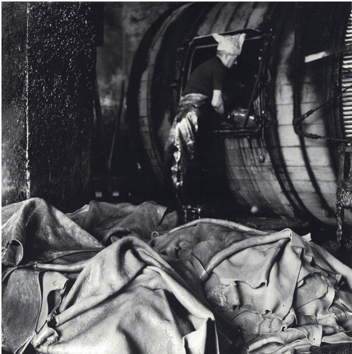
Fase della sbottatura con pelli in primo piano
