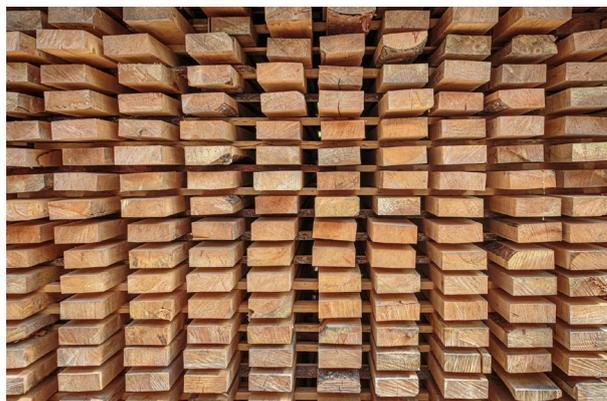
*Figura 7* Stagionatura naturale in cataste tramite l'impiego di listelli distanziatori.
