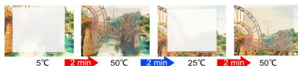
**Figura 7** Schema relativo al funzionamento del legno trasparente termoreversibile (SBO/TW).
