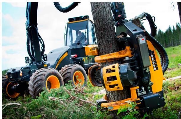
*Figura 5* Abbattimento di un albero attraverso un veicolo raccoglitore.
