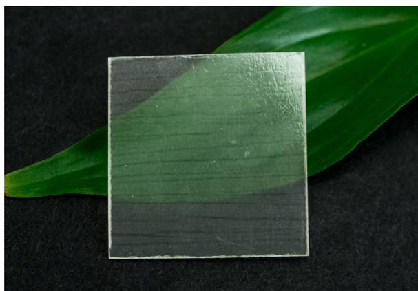
*Figura 5* Campione di legno trasparente infiltrato con limonene acrilato.
