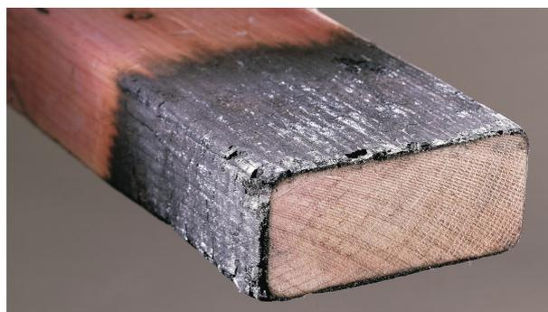
**Figura 20** Immagine di un elemento in legno trattato con un prodotto ritardante di fiamma a seguito della sua esposizione all'azione del fuoco.
