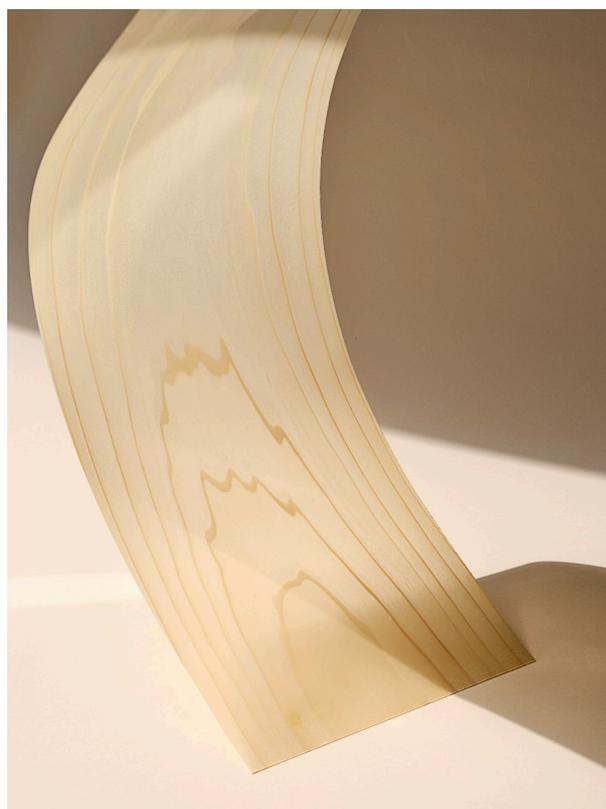
**Figura 2** Interazione con la luce di un campione di legno traslucido.
