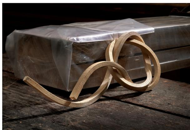
**Figura 5** Campione di legno piegato con la macchina industriale brevettata da Compwood.
