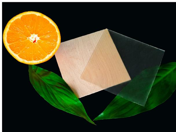
**Figura 3** Campione di legno trasparente ottenuto impiegando il poli(limonene acrilato) (PLIMA).
