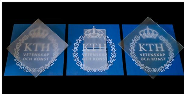
**Figura 3** Confronto tra vari campioni di legno trasparente ottenuti con diversi metodi di infiltrazione.
