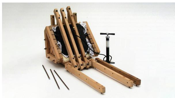
**Figura 10** La Kazam machine impiegata da Eames e Saarinen nella realizzazione della LCW.
