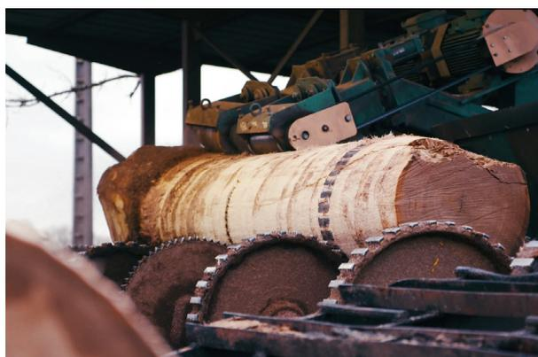
*Figura 6* Scortecciatura meccanica di un tronco.
