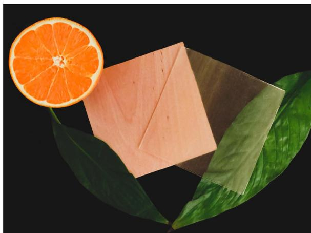
*Figura 4* Confronto di un campione di legno trasparente infiltrato con limonene acrilato con uno di legno normale.
