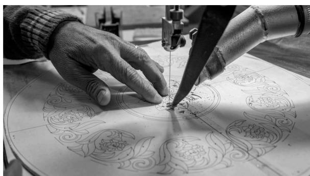
*Figura 68* Taglio del legno tramite traforo.
