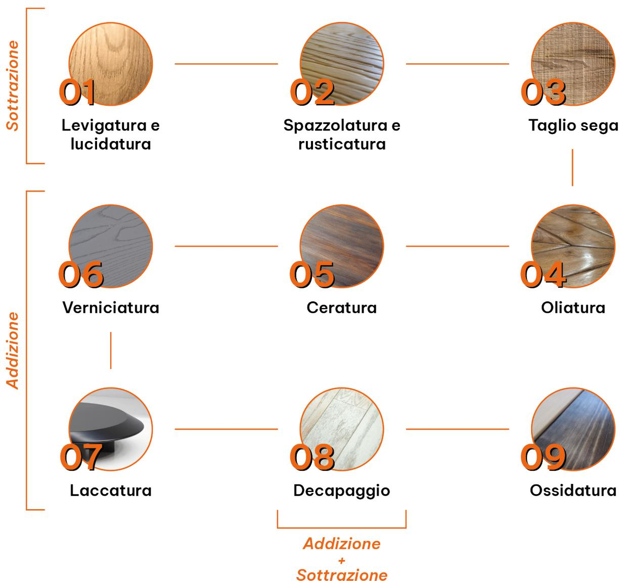
Figura 1 Schema raffigurante le tecniche di finitura che verranno approfondite nelle schedature.
