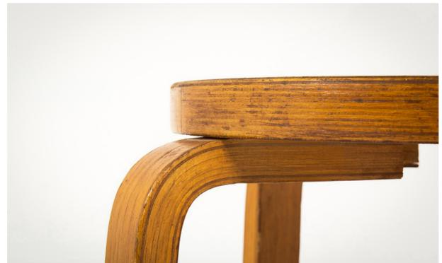
**Figura 7** Sgabello N° 60, dettaglio delle gambe in multistrato curvato, brevetto del 1934.
