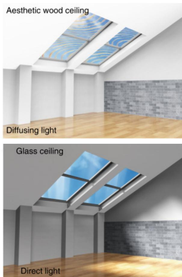
**Figura 15** Confronto tra una finestra in legno traslucido (Aesthetic Wood) e una in vetro.
