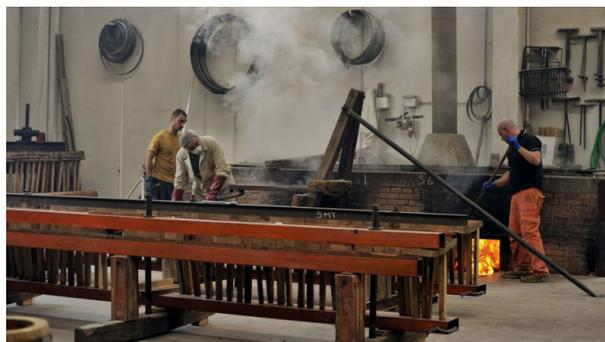
Figura 42 Maestri bottai all'opera durante la realizzazione di una batteria di botti.
