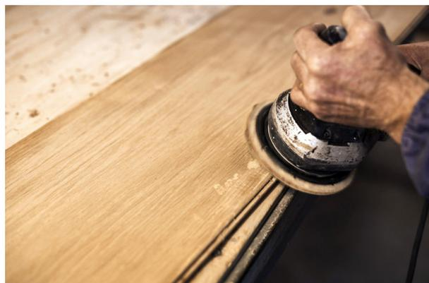
**Figura 8** Lavorazione superficiale di levigatura di un asse di legno.
