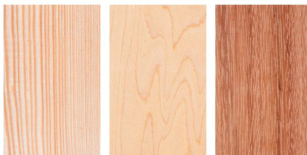
**Figura 18** In ordine da sinistra a destra: fibratura dritta (larice), fibratura ondulata (acero) e fibratura intrecciata (doussié).
