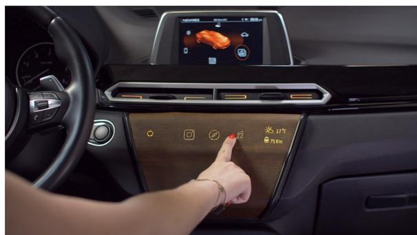
*Figura 1* Prototipo cruscotto di un'automobile con inserti in Ekoa integrati con l'infotainment.
