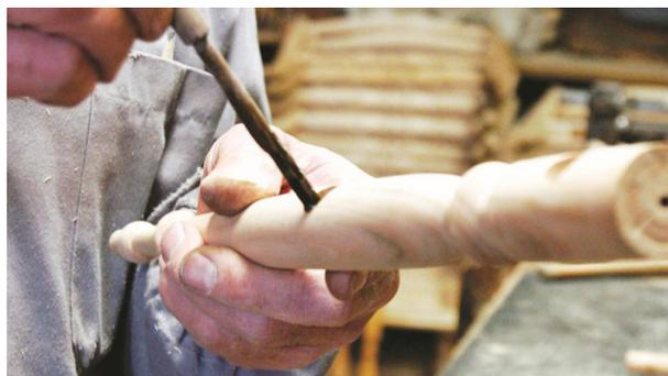
Figura 21 Fase di finitura di una gamba, tornita in precedenza.
