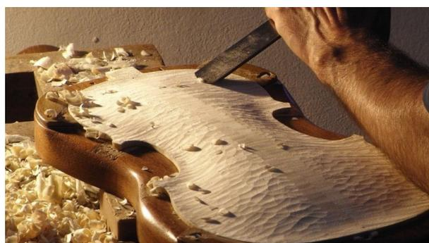
Figura 24 Lavorazione del fondo di un violino.
