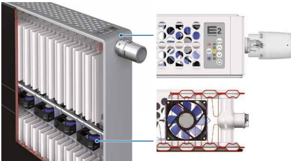
Fig.44: Tecnologia della struttura a piastre integrate con l'ausilio delle ventole [38].
