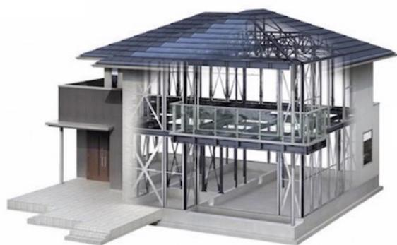
Figura 74 - Esempio progettuale di abitazione con struttura in acciaio e rivestimento a pannelli.
