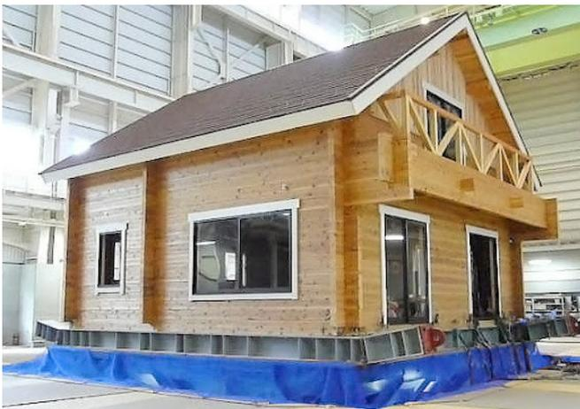
Figura 40 - Esperimento antisismico della Japan Log House Association su un edificio di dimensioni reali.
