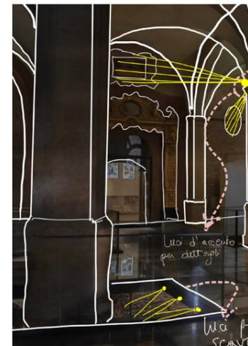
illuminazione delle volte variabile > dimmerazione degli apparecchi per luce più o meno intensa a seconda dell'uso dello spazio
