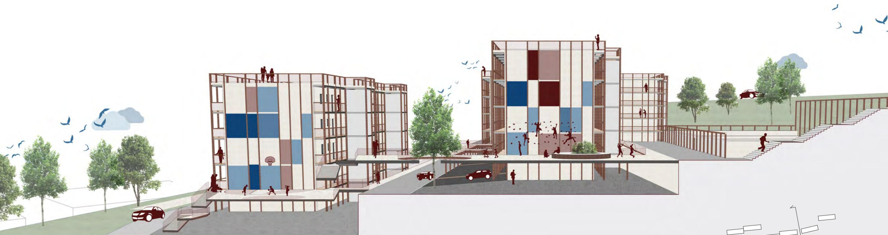
168\_Sezione prospettica passante per l’asse centrale del lotto in corrispondenza della passerella che colma i dislivelli dell’area.
