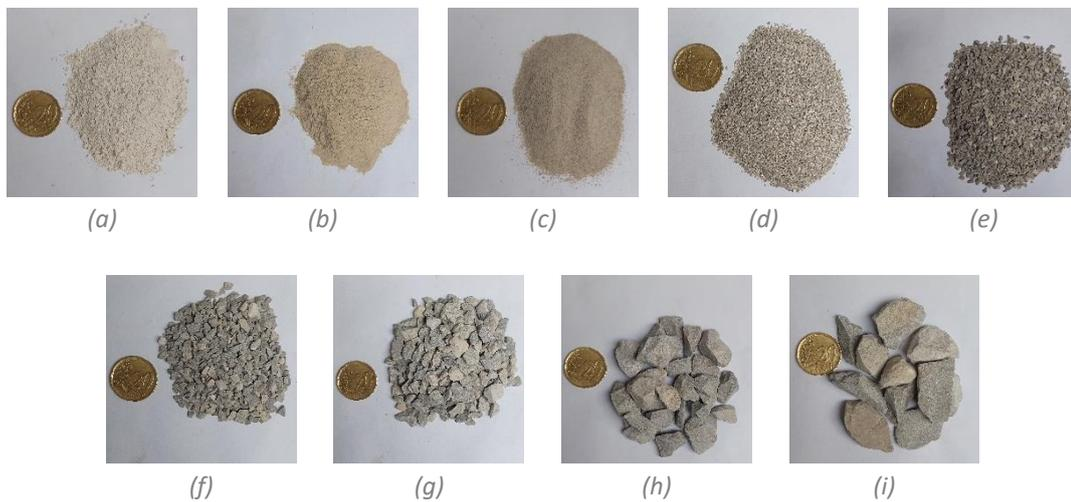
Figura 3 - Frazioni granulometriche dell'aggregato naturale: (a) 0-0,063 mm, (b) 0,063-0,125 mm, (c) 0,125-0,5 mm, (d) 0,5-1 mm, (e) 1-2 mm, (f) 2-4 mm, (g) 4-8 mm, (h) 8-16 mm, (i) 16-20 mm
