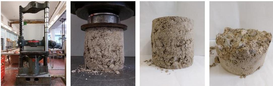
Figura 20 - Esecuzione del test di compressione su provini di diametro 150 mm
