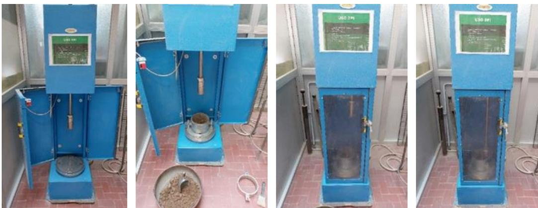
Figura 14 - Fase di esecuzione dello studio Proctor
