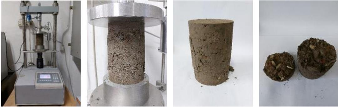
Figura 19 - Esecuzione del test di compressione su provino di diametro 100 mm
