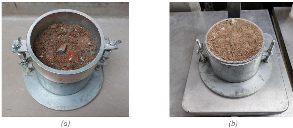
Figura 16 - Campione (a) al termine del costipamento e (b) dopo la rimozione del materiale in eccesso
