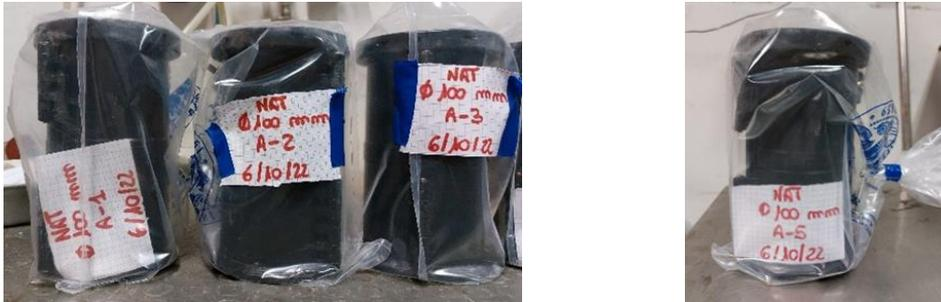
Figura 11 - Provini di diametro 100 mm sigillati dopo il confezionamento
