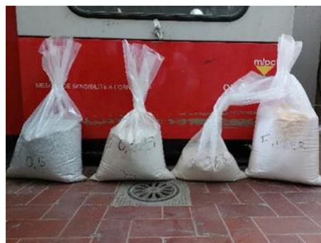
Figura 5 - Stoccaggio delle frazioni granulometriche in sacchetti impermeabili
