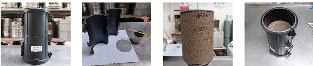
Figura 10 - Fustelle cilindriche utilizzate per la fase di stoccaggio
