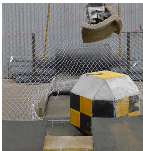
Figura 69: Esempio di rete lacerata in seguito ad impatto di collaudo. [60]
