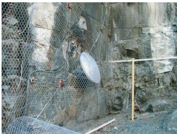
Figura 76: Caso di scivolamento del sistema di prova al di sotto delle funi ad X. [62]
