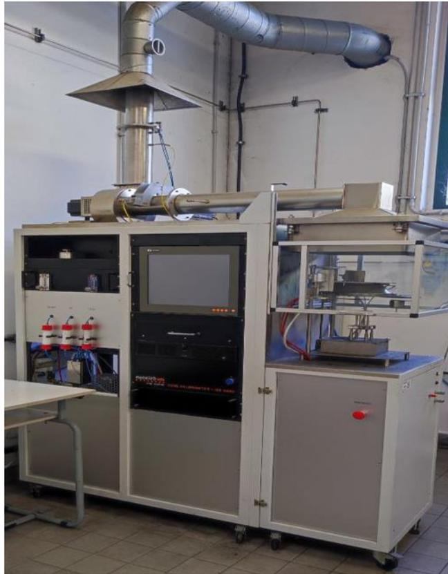
**Figura 2.5** – Cono calorimetro a consumo di ossigeno
