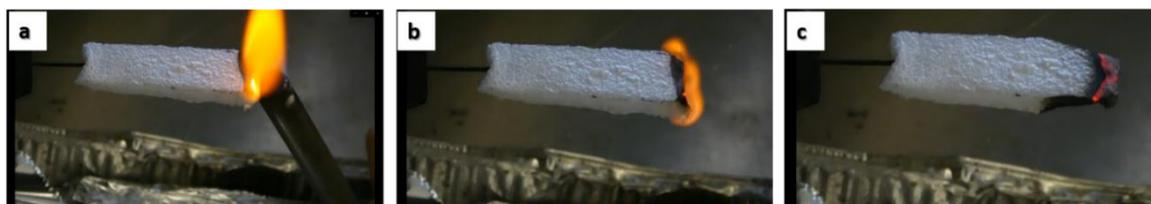
**Figura 3.8** – Immagini della prova di infiammabilità UL-94 in configurazione orizzontale dell'aerogel di CNF
