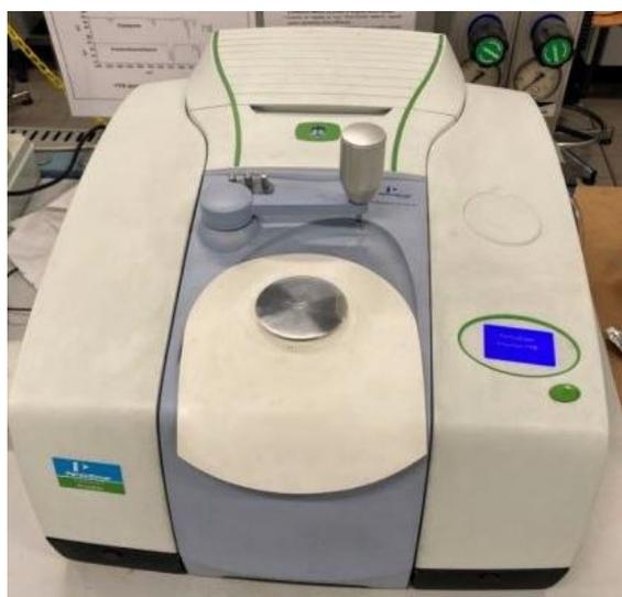
*Figura 2.3* - Spettrofotometro FT-IT in configurazione ATR
