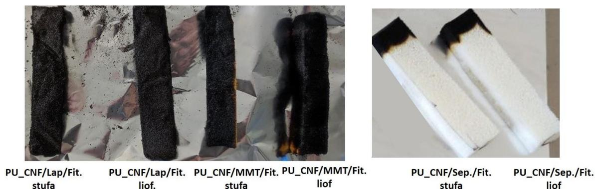
*Figura 3.19* – Residui campioni dopo il test di infiammabilità
