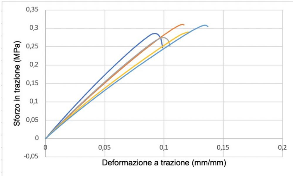
**Figura 3.11:** Sforzo in trazione in funzione della deformazione a trazione per cinque campioni aventi rapporto AH : E pari a 1,3 : 1 sottoposto a ciclo di indurimento 3b.
