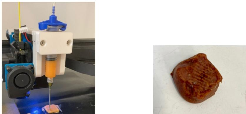
**Figura 3.19:** stampa di un oggetto di forma cubica tramite 3D printing della pasta composita JN1\_C30 (a sinistra) e oggetto ottenuto al termine di tale stampa e reticolato tramite il ciclo di indurimento 3b (a destra).
