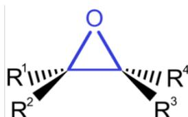
**Figura 1.1:** Struttura di un epossido, con il gruppo epossidico evidenziato in blu, tratta da Guenter Siemel, Robert Rieth, and Kenneth T. Rowbottom, 2000.
