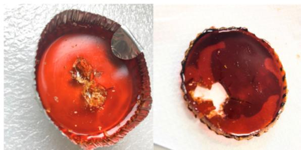
**Figura 3.8:** Campioni sottoposti a due differenti cicli di indurimento, fino a 130° C a sinistra e fino a 170° C a destra.
