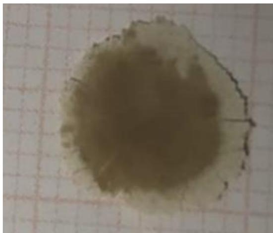
Figura 4.20 Pastiglia  $\text{In}_{40}\text{Zr}_{60}$  invecchiato e diluito.
