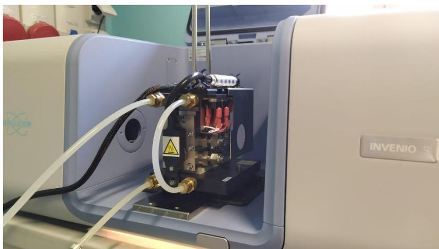
Figura 3.6 Immagine della cella "in operando" impiegata per le analisi FT-IR.
