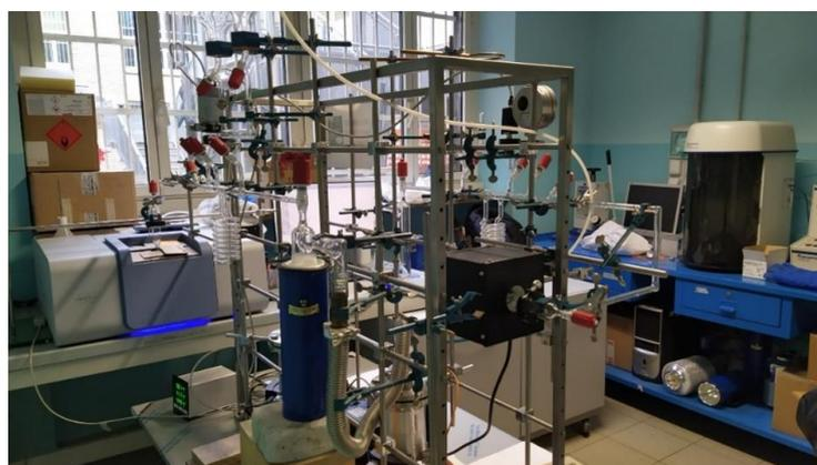
Figura 3.3 Immagine della *vacuum line* con, in primo piano, la linea di analisi collegata con la cella.
