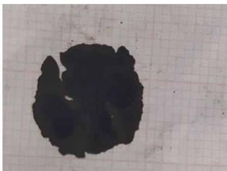
Figura 4.72 Pastiglia di  $\text{Cu}_{60}\text{Ce}_{40}$  calcinato mi miscelato con KBr.
