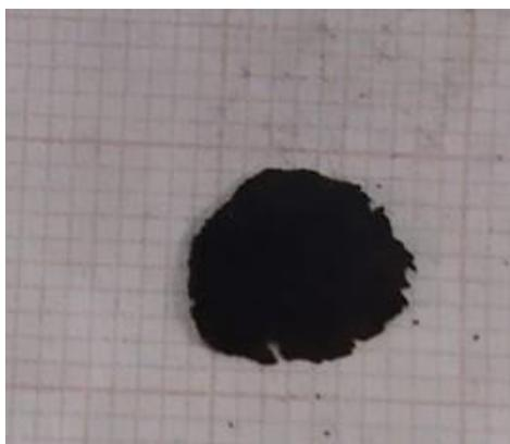
Figura 4.32 *Pastiglia di  $\text{Cu}_{80}\text{Ce}_{20}$  calcinato.*
