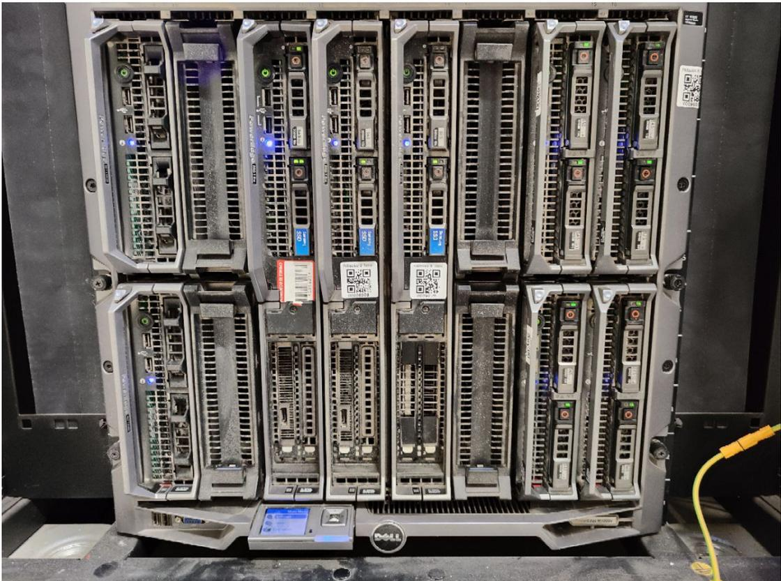
**Figura 4.55:** *blade-server* ricoperti di polvere in un rack del modulo 1
