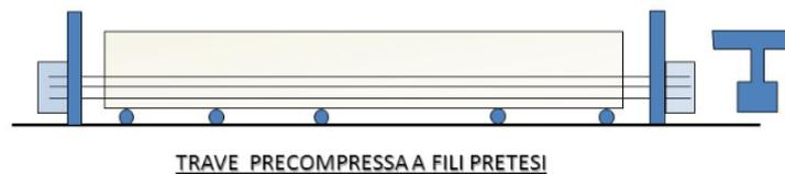
Figura 32: Pre-tensione a cavi aderenti
