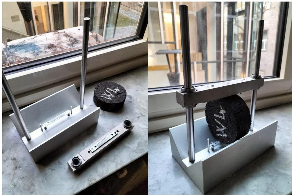
*Figura 38 Fissaggio barre porta trasduttori.*
