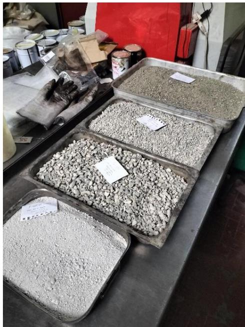
*Figura 6 Aggregati pesati e proporzionati per la miscela.*
