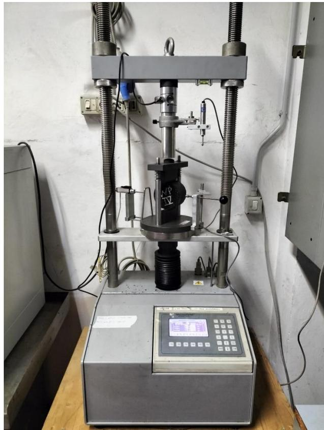
*Figura 33 Pressa statica utilizzata per la prova.*
