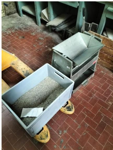
Figura 5 Aggregati selezionati e dispositivo di quartatura.
