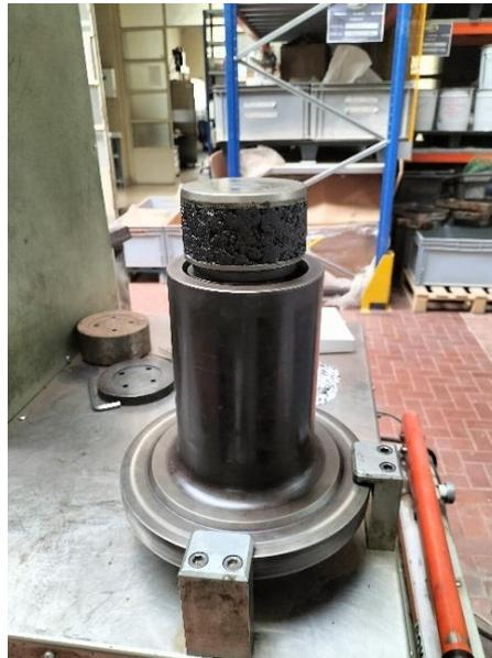
*Figura 26 Estrusione del campione.*
