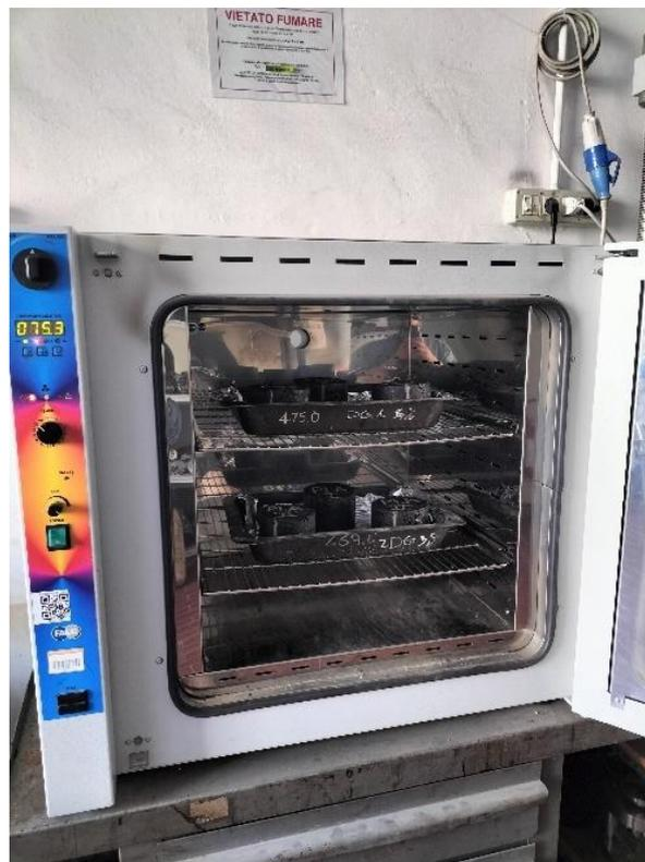
*Figura 32 Campioni posizionati in forno per il condizionamento a lungo termine.*
