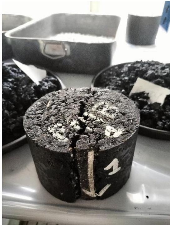
*Figura 59 Rottura del campione al termine della prova.*
