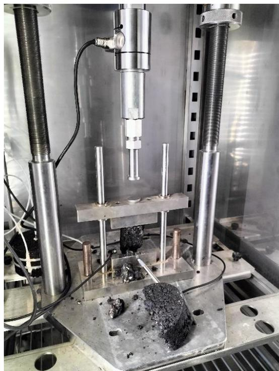
*Figura 42 Rottura del campione al termine della prova.*
