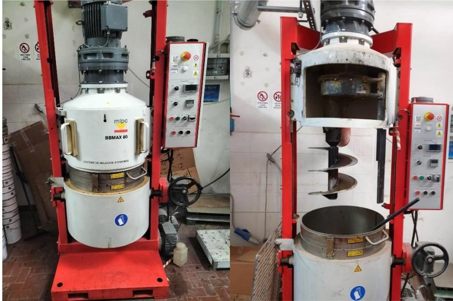
Figura 4 Miscelatore automatico BBMAX 80
