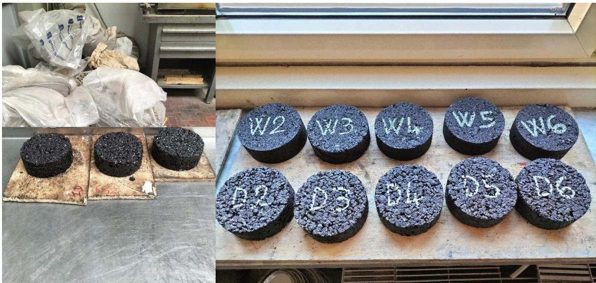
*Figura 37 Campioni realizzati con pressa a taglio giratorio*
