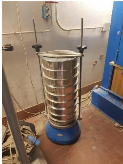
*Figura 20 Colonna di setacci durante l'azione dell'agitatore.*
