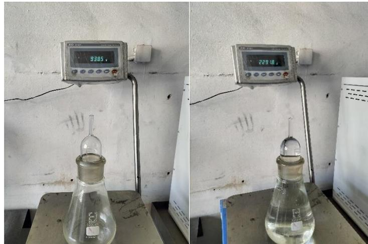
*Figura 8 Taratura dei picnometri.*
