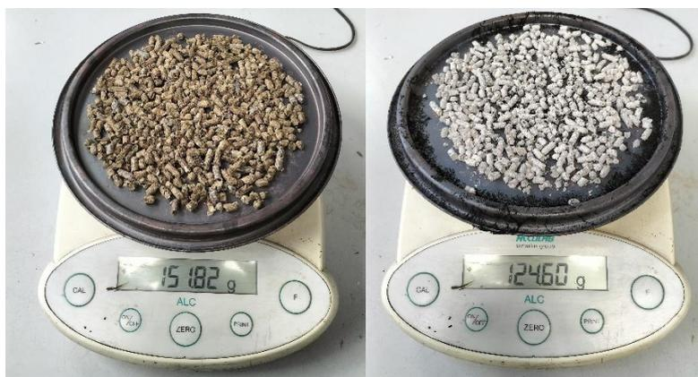
Figura 17 Perdite in peso delle fibre.
