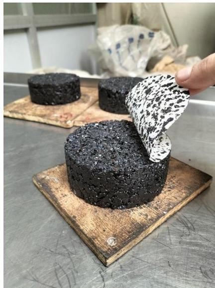
*Figura 27 Rimozione dei filtri.*
