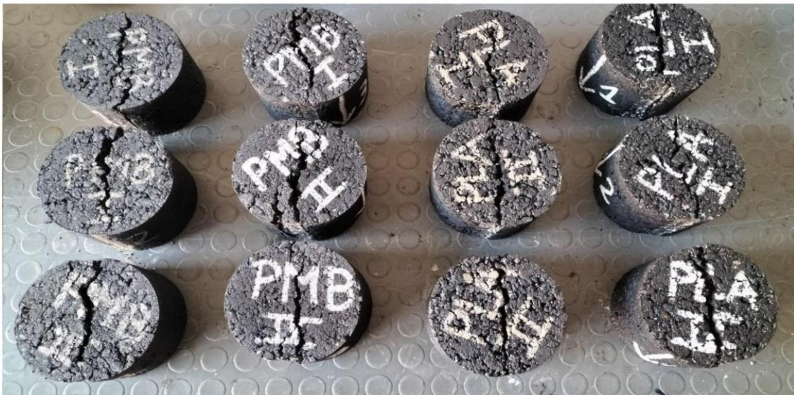
*Figura 60 Rottura dei campioni al termine della prova.*
