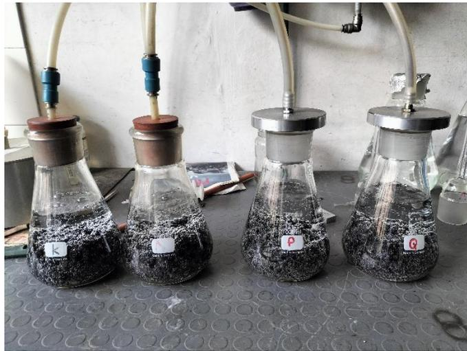
*Figura 10 Processo di disareazione delle miscele.*
