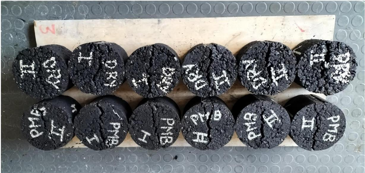
*Figura 61 Rottura dei campioni al termine della prova.*
