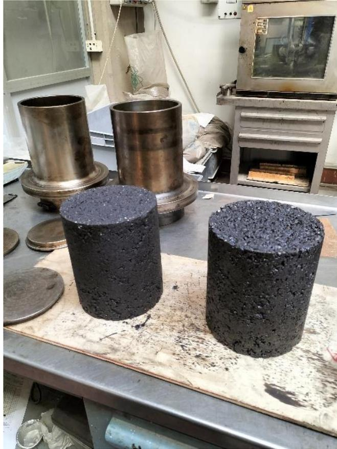
Figura 44 Campioni realizzati con pressa a taglio giratorio, dimensioni 150x180.
