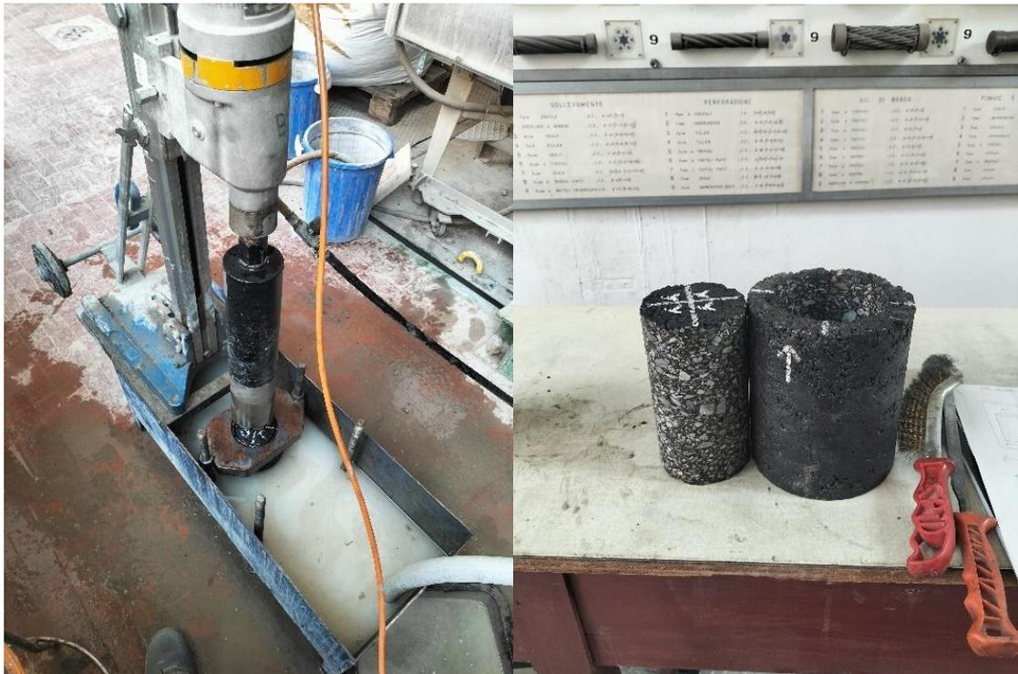
Figura 45 Fase di carotaggio del campione.
