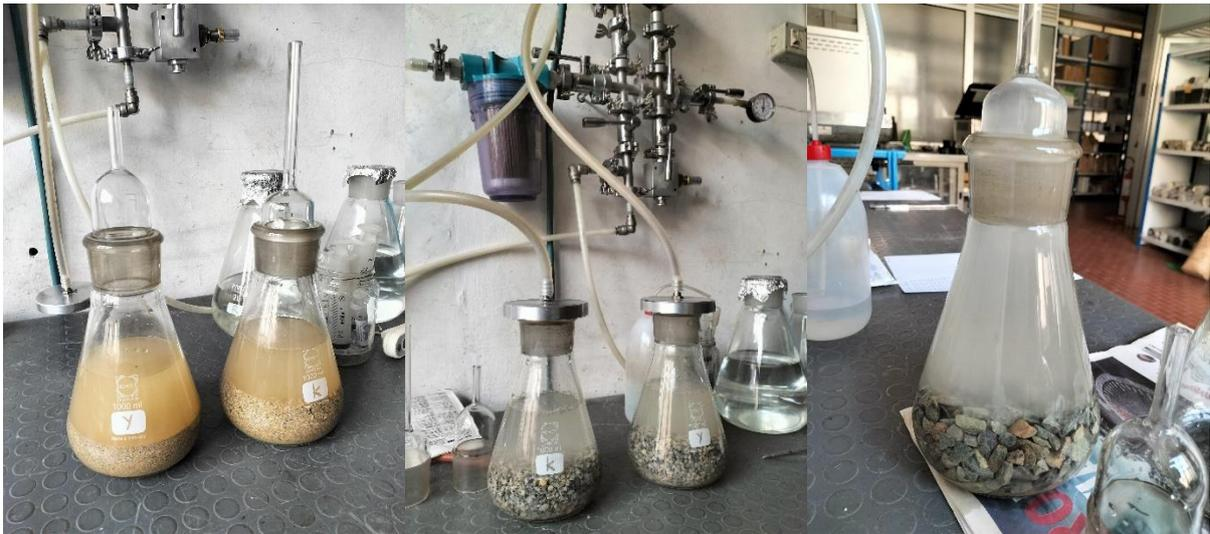
*Figura 12 Processo di disareazione degli aggregati.*
