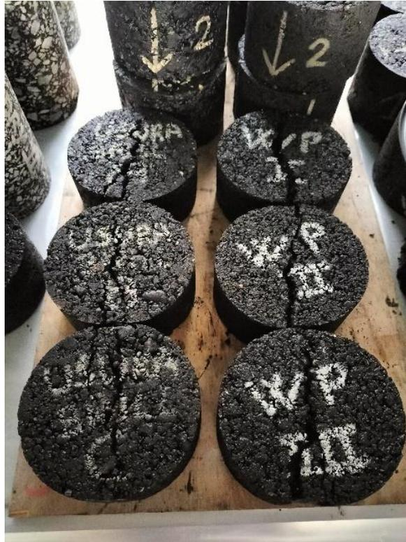
*Figura 62 Rottura dei campioni al termine della prova.*
