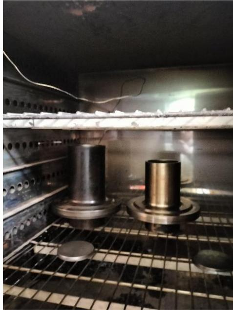
*Figura 23 Fustelle in forno a condizionare.*
