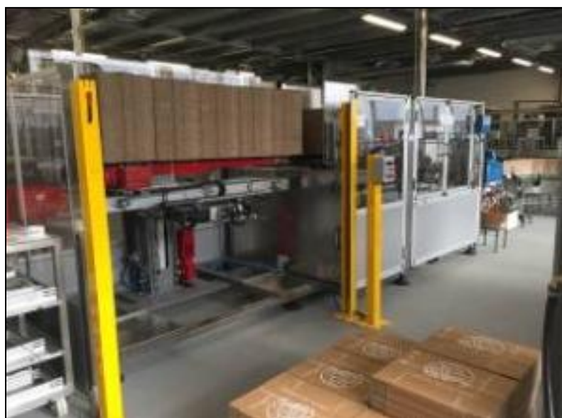
Figura 3.12 Magazzino formatrice cartoni, posizionamento per prelievo macchina
