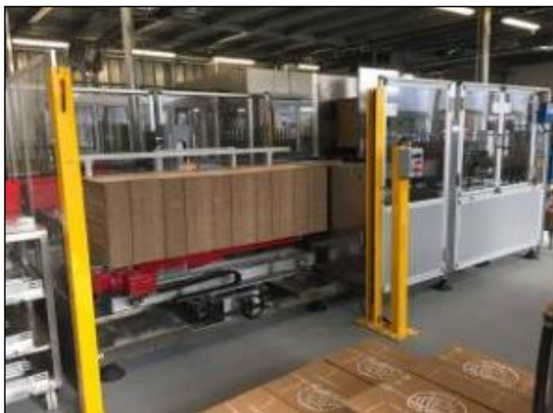
Figura 3.11 Magazzino formatrice cartoni posizionamento per carico cartoni
