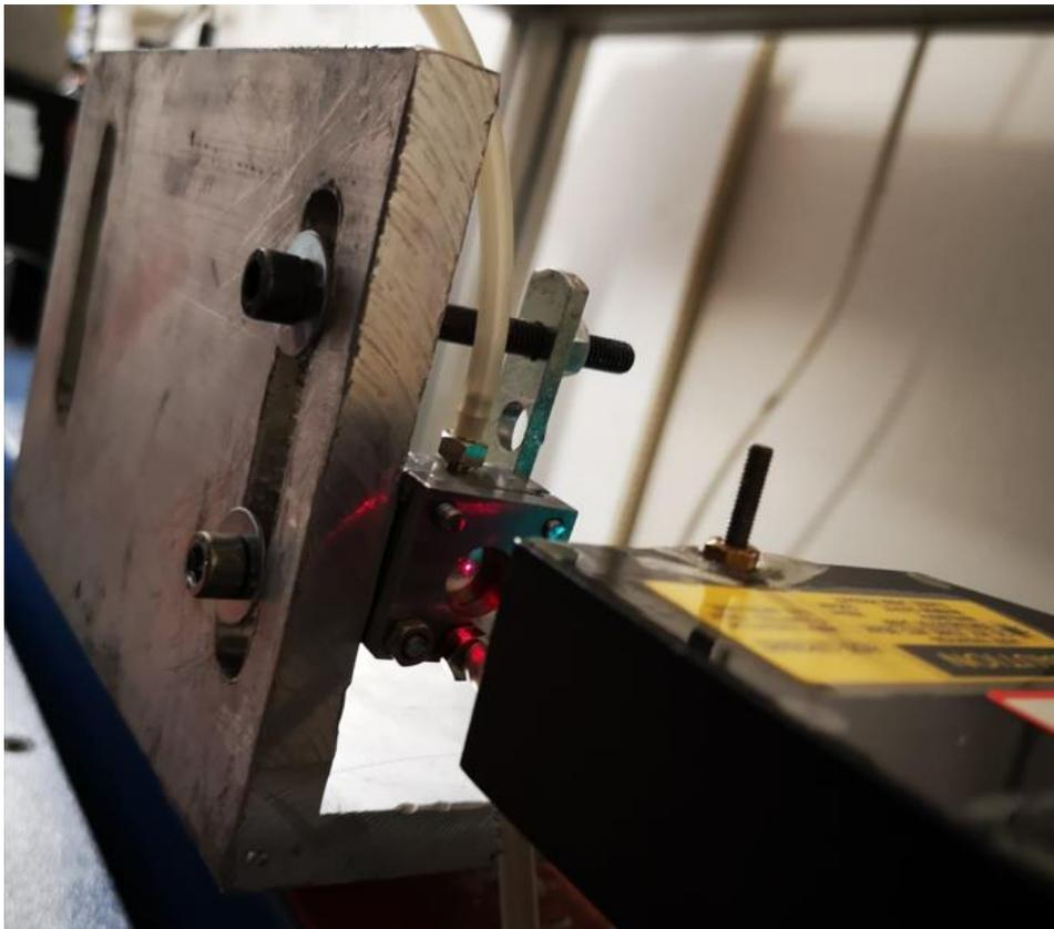
**Figura 2.17** Fascio laser che punta in direzione del centro della membrana in prova
