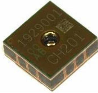
**Figura 2.1:** Un esempio di circuito integrato che racchiude in un unico package di soli 3,5 mm di lato un sensore di distanza a ultrasuoni[15].
