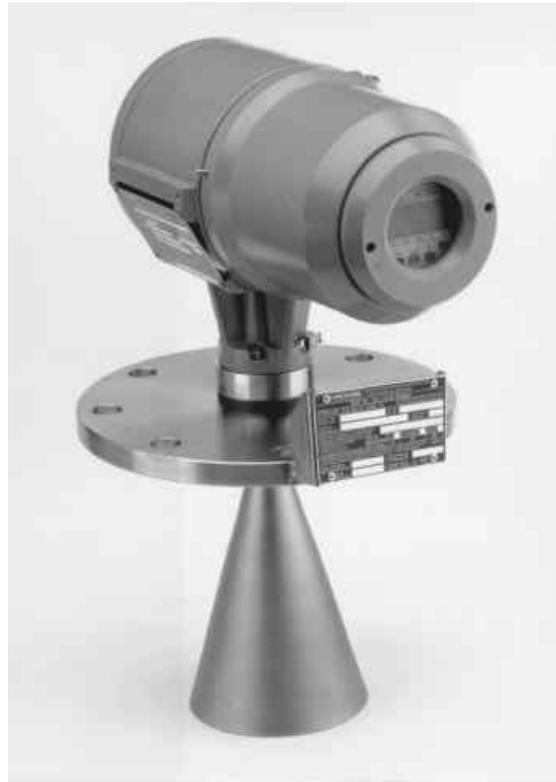
**Figura 2.14:** Design di un sistema radar compatto di tipo industriale. Il convertitore al di sopra della flangia include tutta la circuiteria a microonde, gli stadi di processamento del segnale, il controllo a microprocessore, display, alimentatore, e segnali di uscita [2][27].
