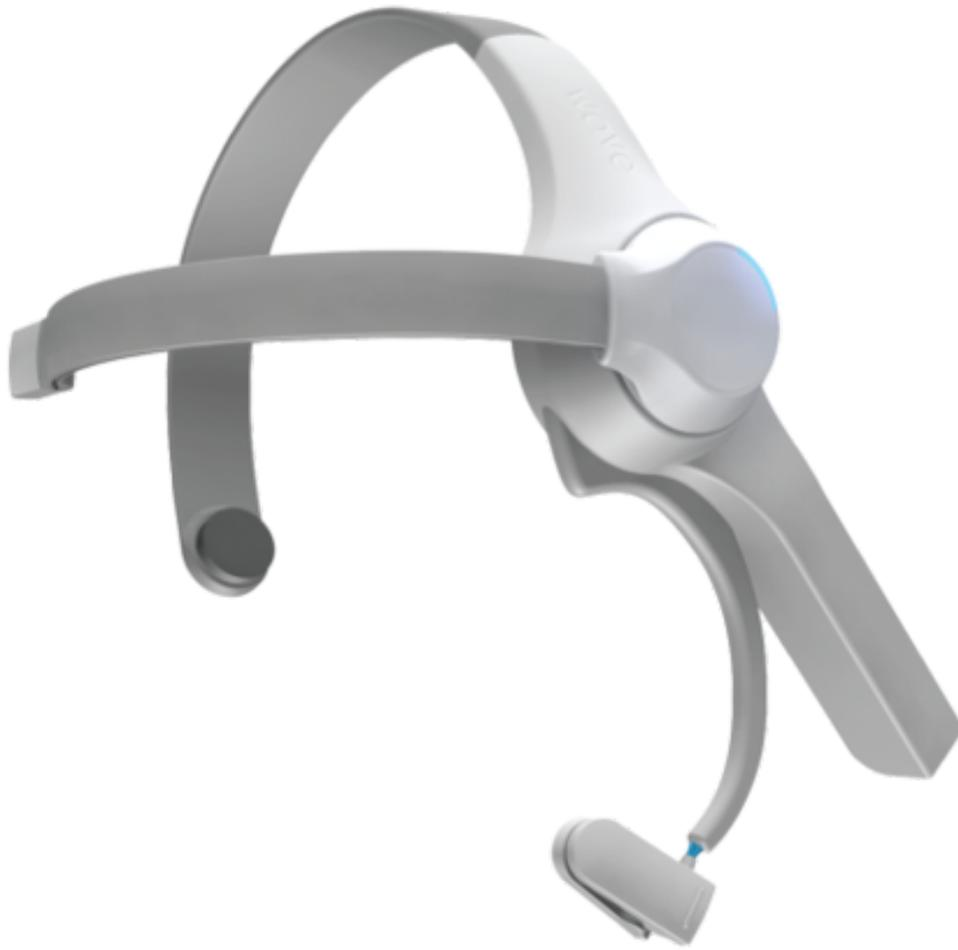
**Figura 4.6:** Neurosky Mindwave, un dispositivo EEG differenziale di livello consumer con due canali, di cui uno di riferimento. Frequenza di campionamento: 512Hz.
