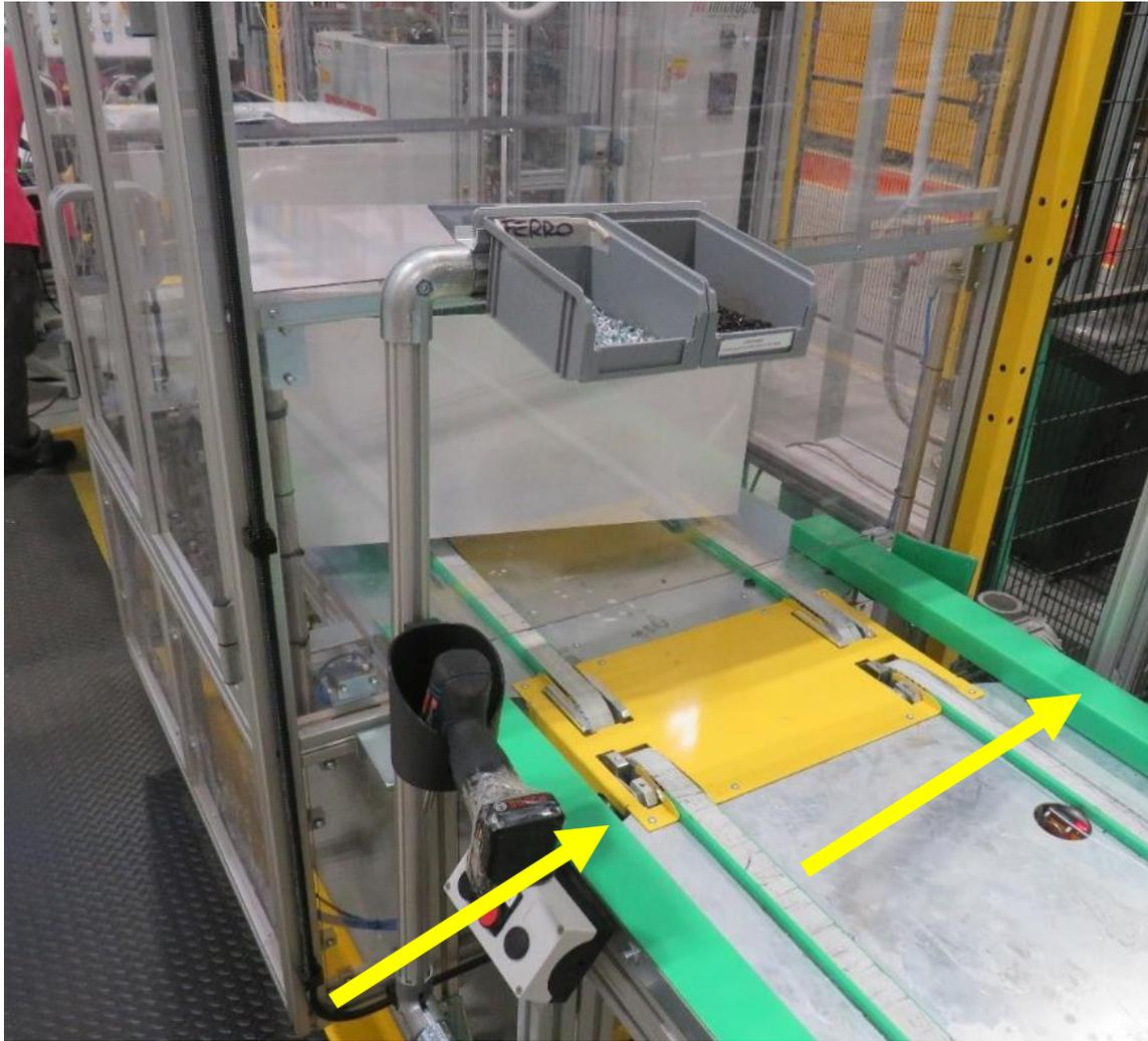
*Figura 29 Rappresentazione dei binari per il posizionamento corretto del modello B*
