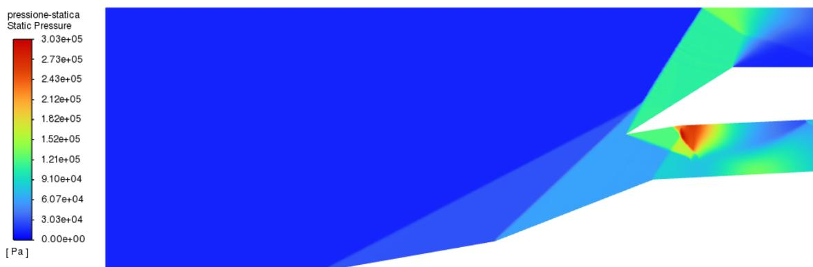
Figura 5.13: *Comportamento della pressione statica per la geometria CA a  $M = 3$  e  $p_0 = 15000$  Pa, con griglia di 396977 elementi, Modello Spalart-Allmaras*
