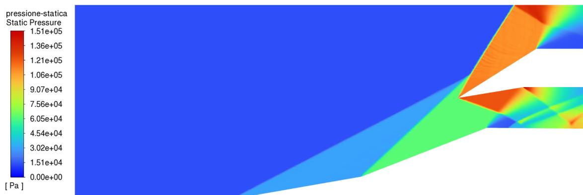
Figura 6.27: Comportamento della pressione statica per la geometria BC a  $M = 3$  e  $p_0 = 15000 Pa$ , con griglia di 396977 elementi, Modello SST  $k - \omega$
