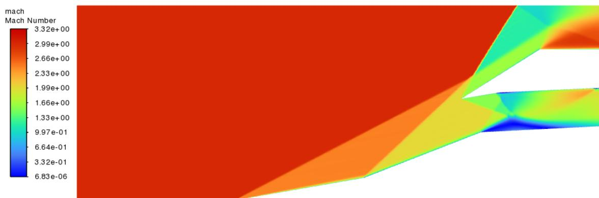
Figura 5.12: *Comportamento del numero di Mach per la geometria CA a  $M = 3$  e  $p_0 = 15000$  Pa, con griglia di 396977 elementi, Modello Spalart-Allmaras*
