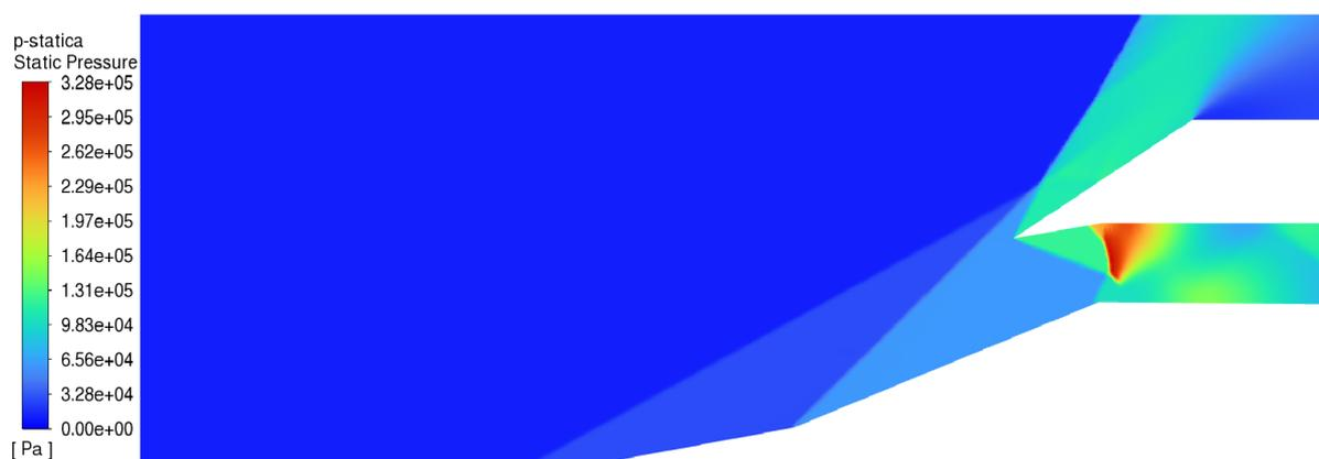
Figura 6.8: Comportamento della pressione statica per la geometria CA a  $M = 3$  e  $p_0 = 15000 Pa$ , con griglia di 396977 elementi, Modello Realizable  $k - \epsilon$
