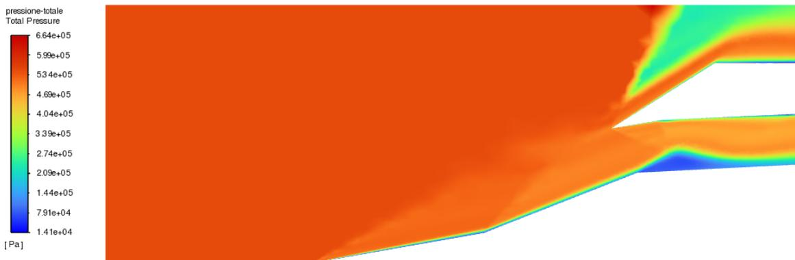
Figura 5.35: *Comportamento della pressione totale per la geometria CA a  $M = 3$  e  $p_0 = 15000 Pa$ , con griglia di 30148 elementi, Modello Spalart-Allmaras*
