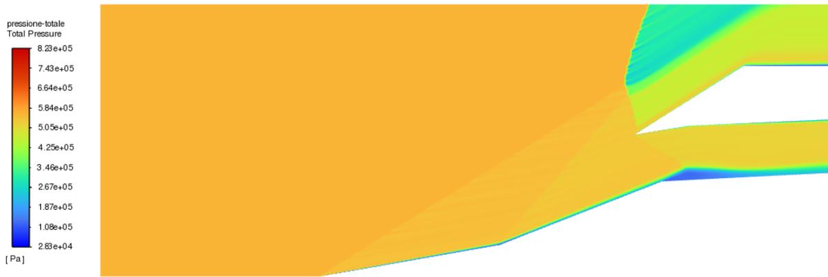
Figura 6.14: Comportamento della pressione totale per la geometria CA a  $M = 2.5$  e  $p_0 = 33000 Pa$ , con griglia di 396977 elementi, Modello SST  $k - \omega$
