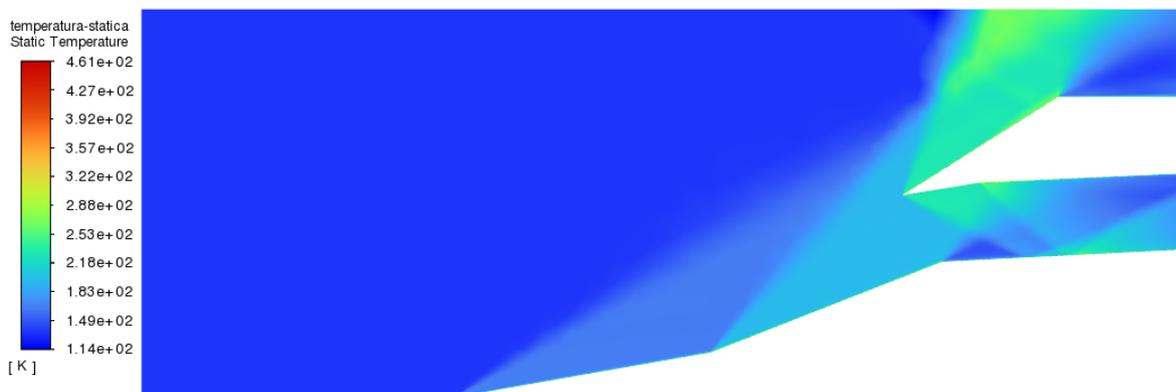
Figura 5.32: *Comportamento della temperatura statica per la geometria CA a  $M = 2.5$  e  $p_0 = 33000 Pa$ , con griglia di 30148 elementi, Modello Spalart-Allmaras*
