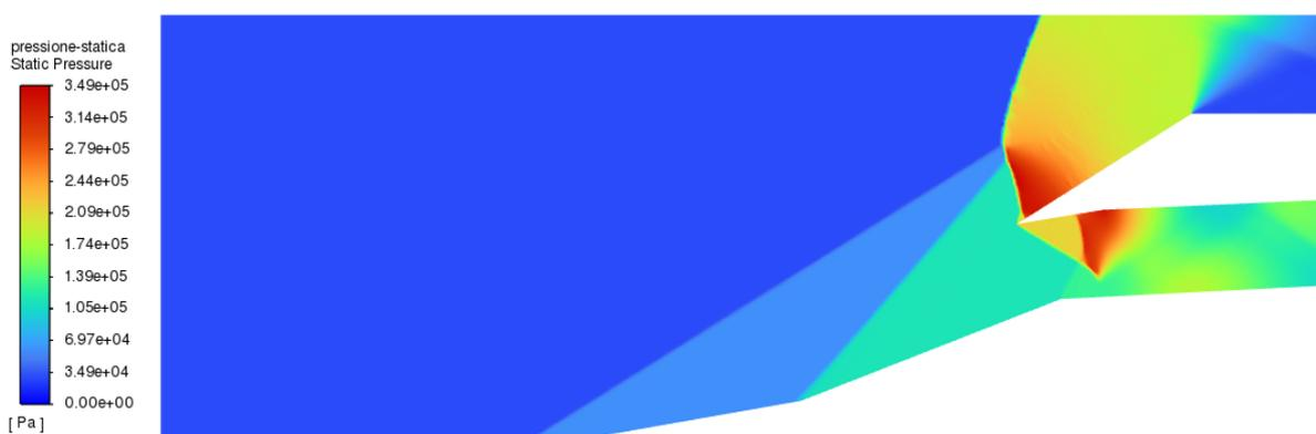
Figura 6.13: Comportamento della pressione statica per la geometria CA a  $M = 2.5$  e  $p_0 = 33000 Pa$ , con griglia di 396977 elementi, Modello SST  $k - \omega$
