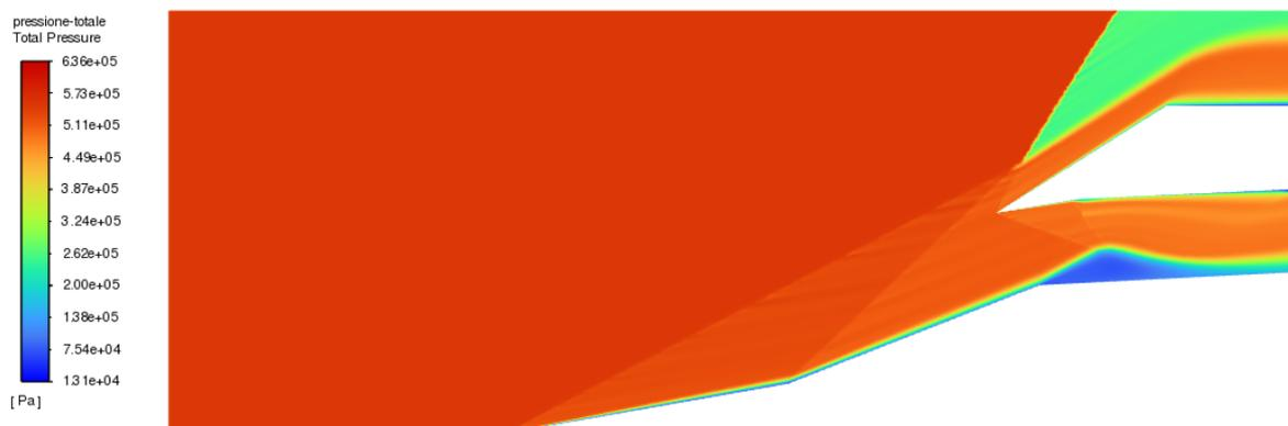
Figura 5.14: *Comportamento della pressione totale per la geometria CA a  $M = 3$  e  $p_0 = 15000$  Pa, con griglia di 396977 elementi, Modello Spalart-Allmaras*
