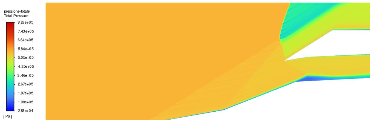
Figura 6.5: Comportamento della pressione totale per la geometria CA a  $M = 2.5$  e  $p_0 = 33000$  Pa, con griglia di 396977 elementi, Modello Realizable  $k - \epsilon$
