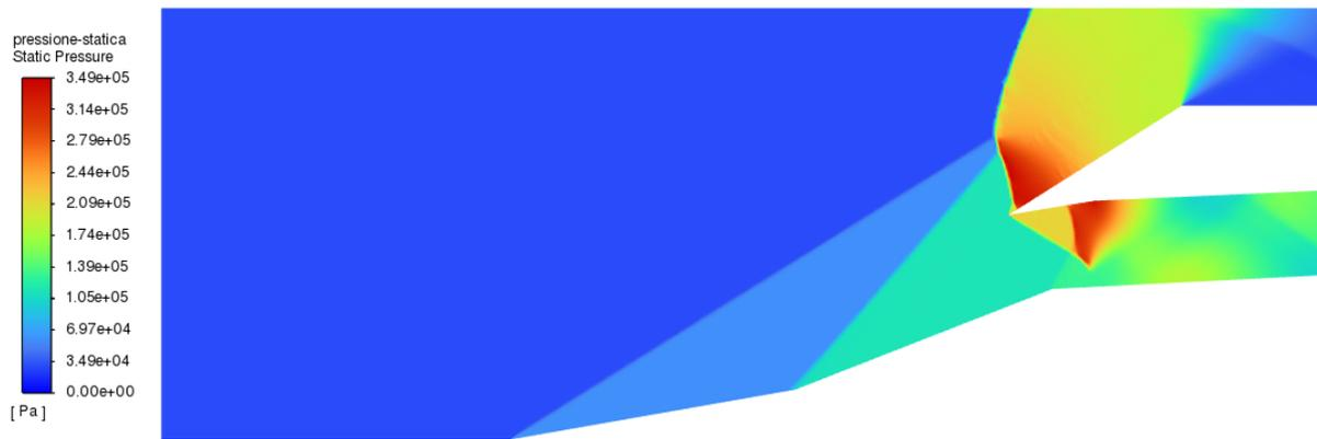
Figura 6.4: Comportamento della pressione statica per la geometria CA a  $M = 2.5$  e  $p_0 = 33000$  Pa, con griglia di 396977 elementi, Modello Realizable  $k - \epsilon$
