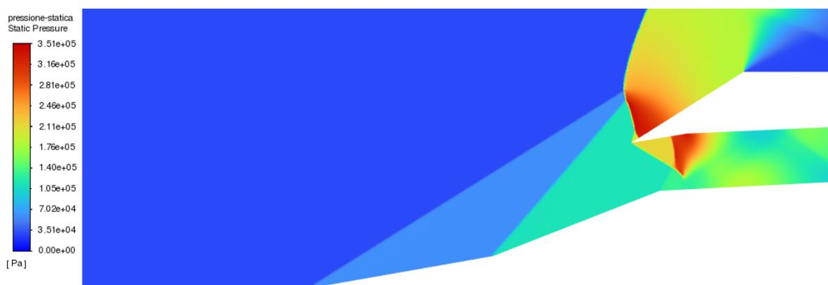
Figura 5.9: Comportamento della pressione statica per la geometria CA a  $M = 2.5$  e  $p_0 = 33000 Pa$ , con griglia di 396977 elementi, Modello Spalart-Allmaras
