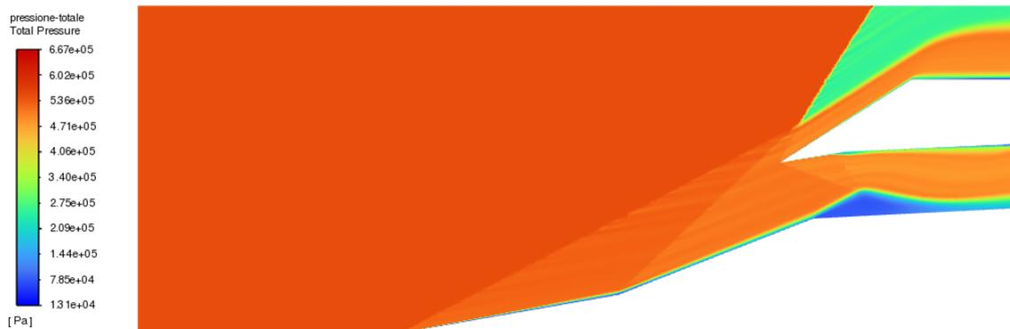
Figura 6.18: Comportamento della pressione totale per la geometria CA a  $M = 3$  e  $p_0 = 15000$  Pa, con griglia di 396977 elementi, Modello SST  $k - \omega$
