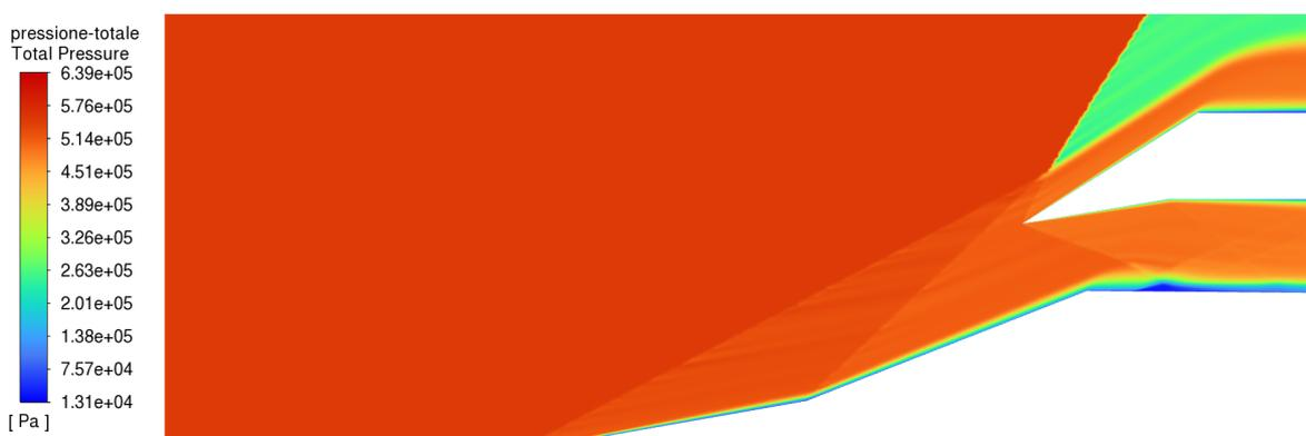
Figura 6.28: Comportamento della pressione totale per la geometria BC a  $M = 3$  e  $p_0 = 15000 Pa$ , con griglia di 396977 elementi, Modello SST  $k - \omega$
