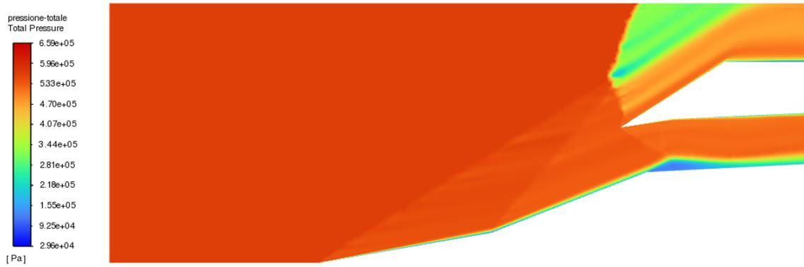
Figura 5.21: *Comportamento della pressione totale per la geometria CA a  $M = 2.5$  e  $p_0 = 33000 Pa$ , con griglia di 114531 elementi, Modello Spalart-Allmaras*
