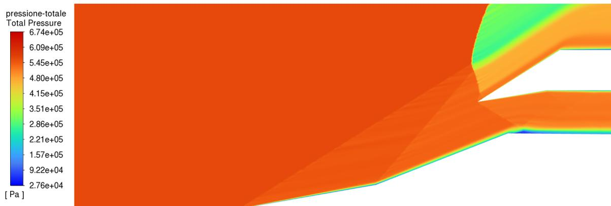
Figura 6.24: Comportamento della pressione totale per la geometria BC a  $M = 2.5$  e  $p_0 = 33000 Pa$ , con griglia di 396977 elementi, Modello SST  $k - \omega$
