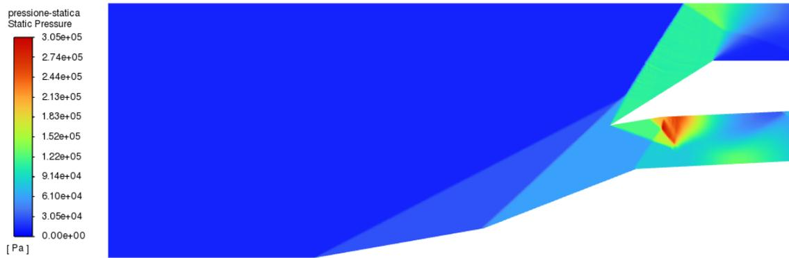
Figura 6.17: Comportamento della pressione statica per la geometria CA a  $M = 3$  e  $p_0 = 15000$  Pa, con griglia di 396977 elementi, Modello SST  $k - \omega$
