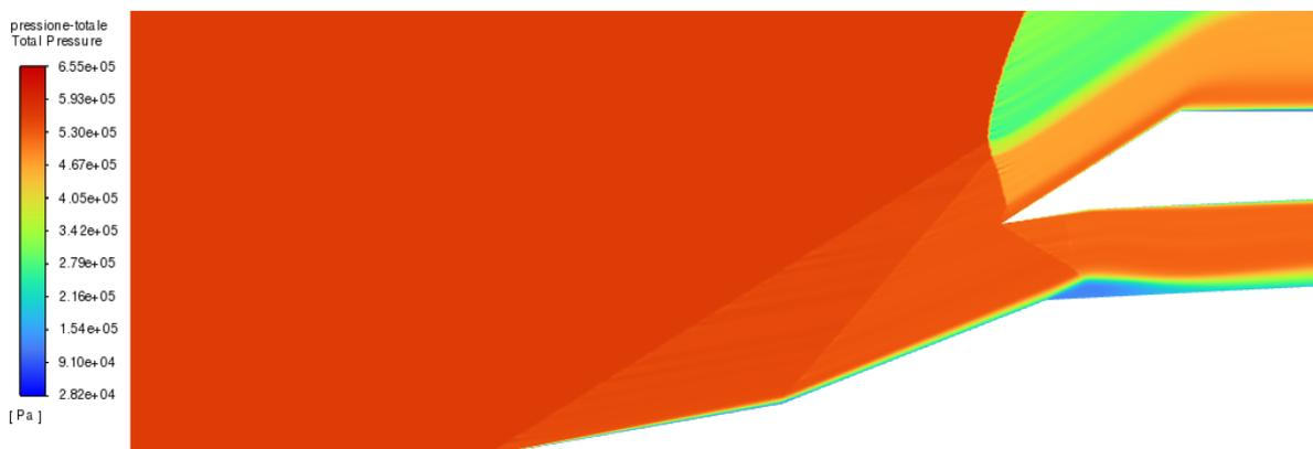
Figura 5.10: Comportamento della pressione totale per la geometria CA a  $M = 2.5$  e  $p_0 = 33000 Pa$ , con griglia di 396977 elementi, Modello Spalart-Allmaras
