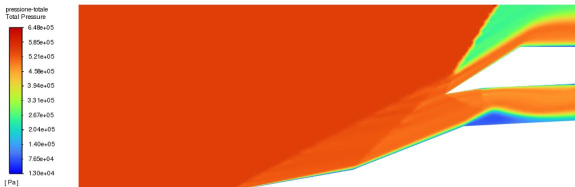
Figura 5.25: *Comportamento della pressione totale per la geometria CA a  $M = 3$  e  $p_0 = 15000 Pa$ , con griglia di 114531 elementi, Modello Spalart-Allmaras*
