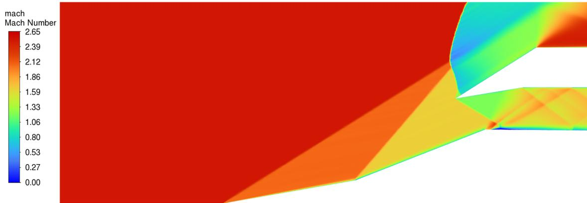
Figura 6.22: *Comportamento del numero di Mach per la geometria BC a  $M = 2.5$  e  $p_0 = 33000 Pa$ , con griglia di 396977 elementi, Modello SST  $k - \omega$*
