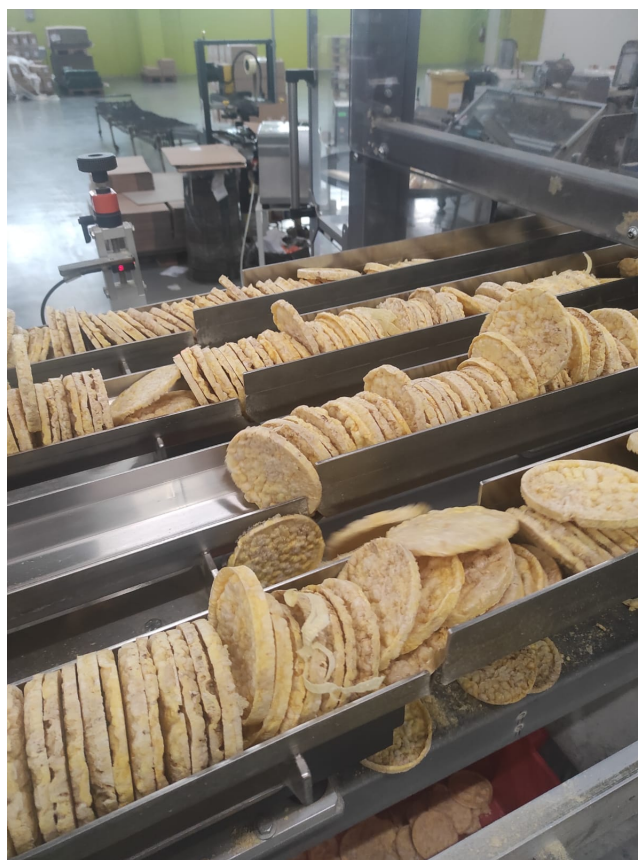
Figura 4.3. Gallette incastrate nella zona "canale"
