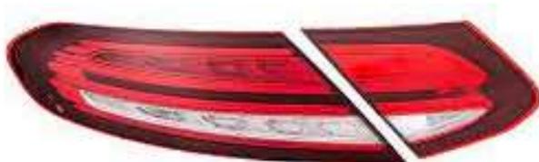
Figura 3.1 – Esempio di fanale nelle componenti T2 (sulla sx) e T1 (sulla dx)
