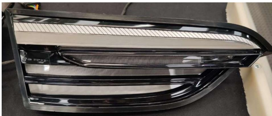
Figura 3.11– T2 a seguito dell'operazione di saldatura in OP20
