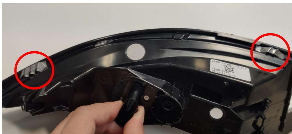
Figura 3.15 – Corretto posizionamento dei film adesivi sul fanale
