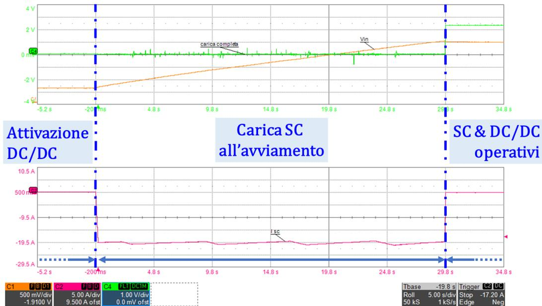
Figura 7.14: Cambiamento degli stati di macchina in base alla corrente di carico (C2  $I_{SC}$ ; C4 *carica\_completa*; C1  $V_{in}$ ).
