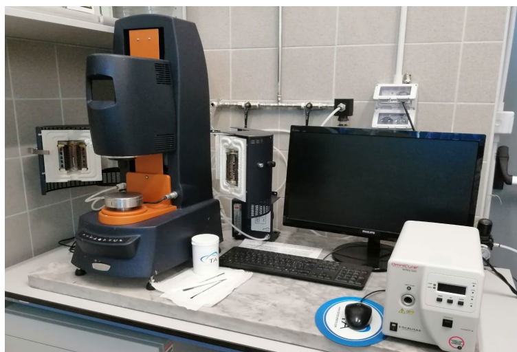
Figura 21: Reometro rotazionale DHR-2
