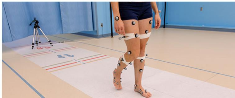
Figura 1.1: Esempio di Analisi del cammino con l'utilizzo del Motion Capture[1].
