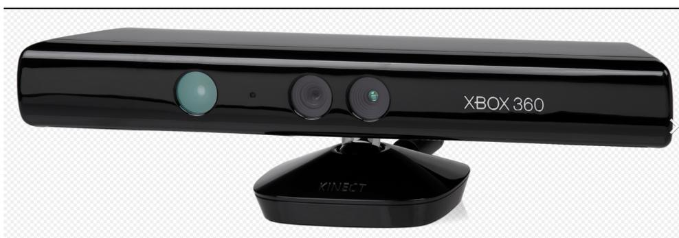
Figura 1.8: Esempio di sensore Microsoft Kinect v1[9].
