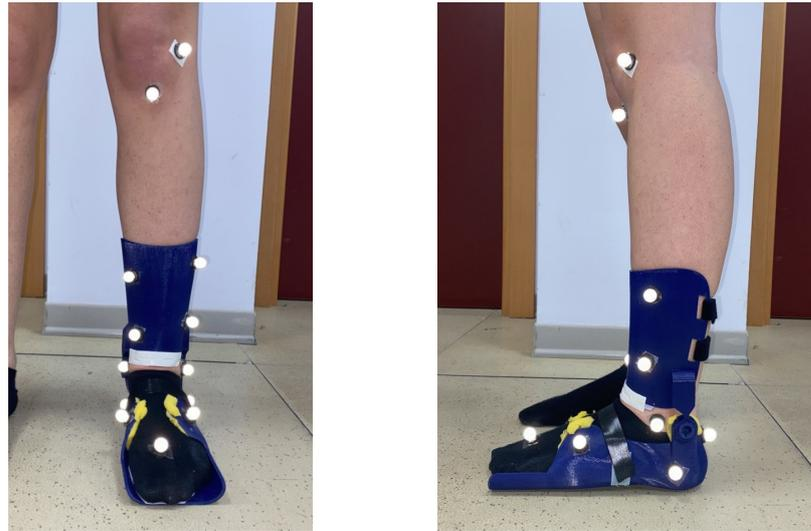
**Figura 8.2:** Posizionamento dei marker (vista frontale a sx e laterale a dx) personalizzato per la prova di dorsi-plantarflexione attiva e per le prove di cammino utili per valutare l'asse di rotazione articolare
