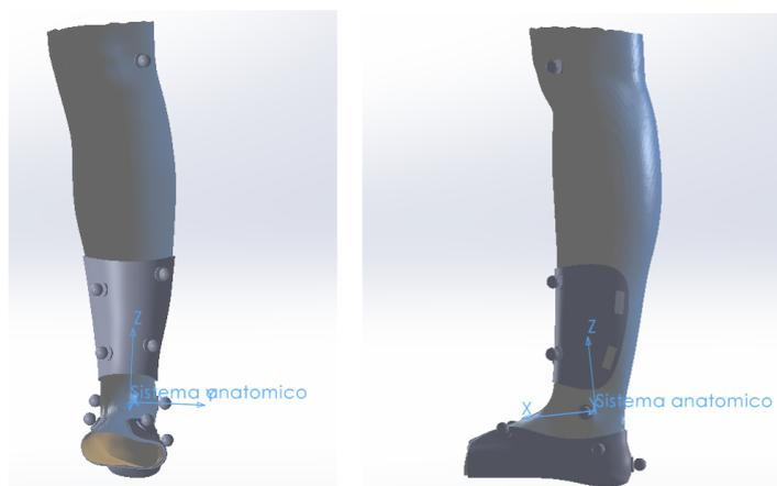
**Figura 6.1:** Sistema di riferimento anatomico importato sul modello Solidworks
