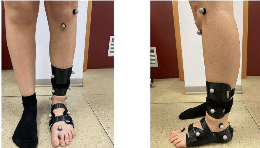
**Figura 5.9:** Posizionamento dei marker sui gusci SolidWorks (vista frontale e laterale)
