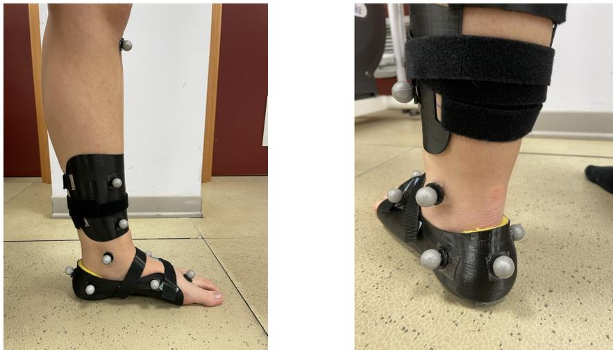
**Figura 5.10:** Posizionamento dei marker sui gusci Solidworks (vista mediale e posteriore)
