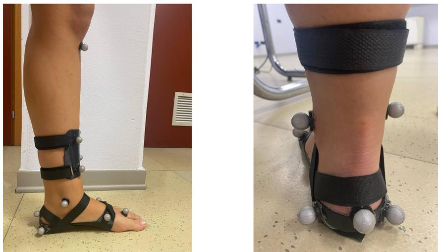
**Figura 5.3:** Posizionamento dei marker sui gusci Rhino (vista mediale e posteriore)
