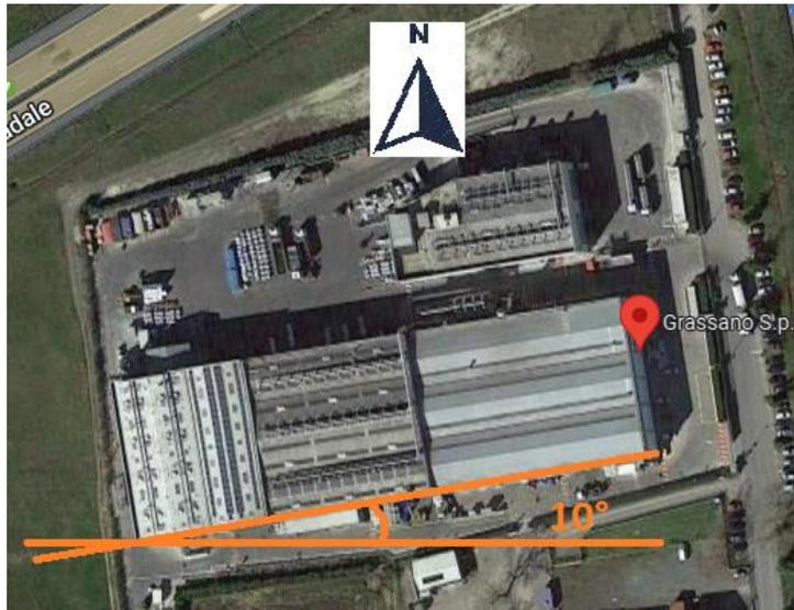
Figura 22 - Angolo di azimut
