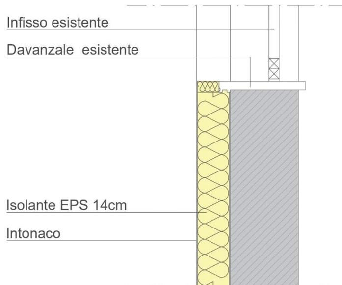
*Figura 37 Dettaglio costruttivo davanzale.*
