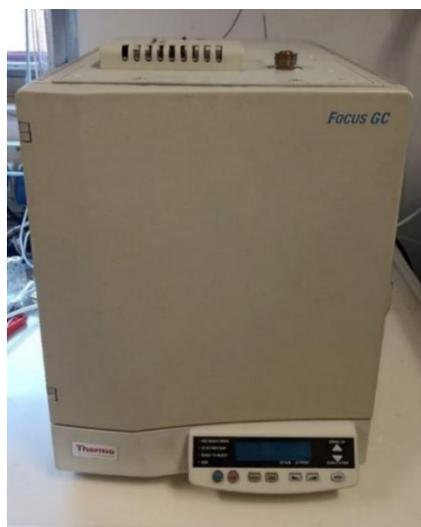
Figura 3.3: Gascromatografo per misure di  $CO_2$  e  $CH_4$
