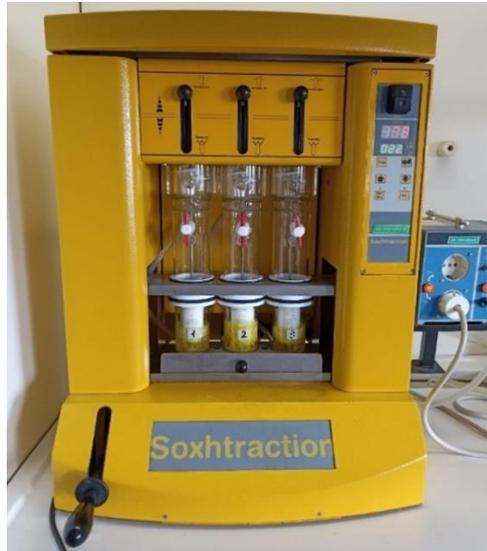
Figura 3.4: Estrattore Soxhlet
