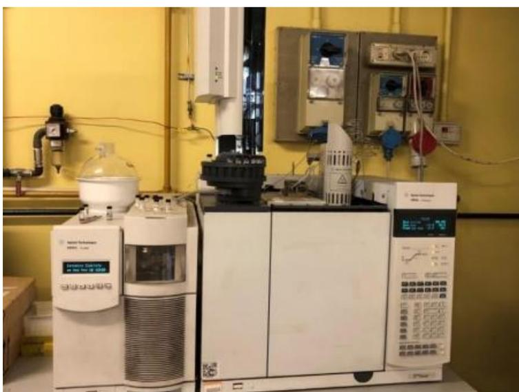
*Figura 21-Gas cromatografo con rilevatore massa 5975C Series GC/MSD System*
