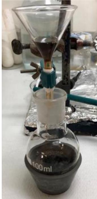
*Figura 19-Filtrazione meccanica per adsorbimento*
