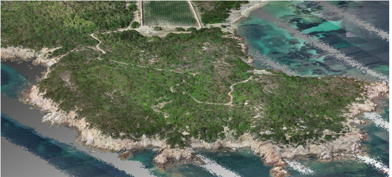
*Figura 9: Elaborazione tridimensionale della nuvola di punti prodotta dal rilievo fotogrammetrico dell'isola (Fonte: Rilievo e post-processing di Lorenzo Teppati Losè, Laboratorio di Geomatica per i Beni Culturali, DAD, Politecnico di Torino)*
