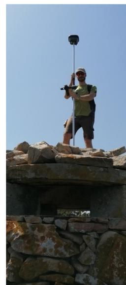
Figura 19: Ricevitore GNSS utilizzato per il rilievo
