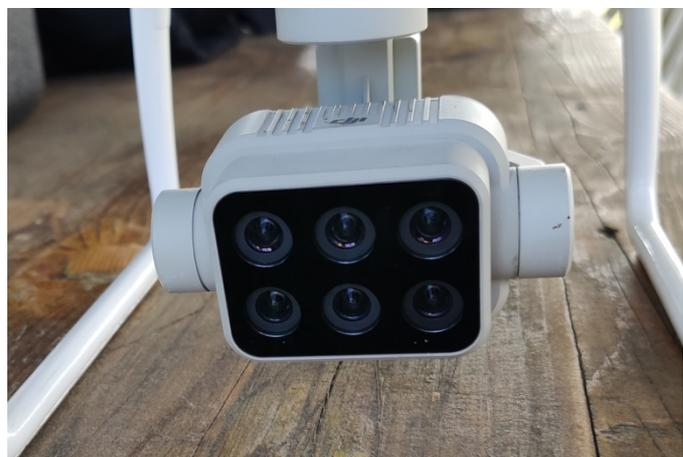
*Figura 23: Camera multispettrale del drone DJI Phantom 4 RTK*
