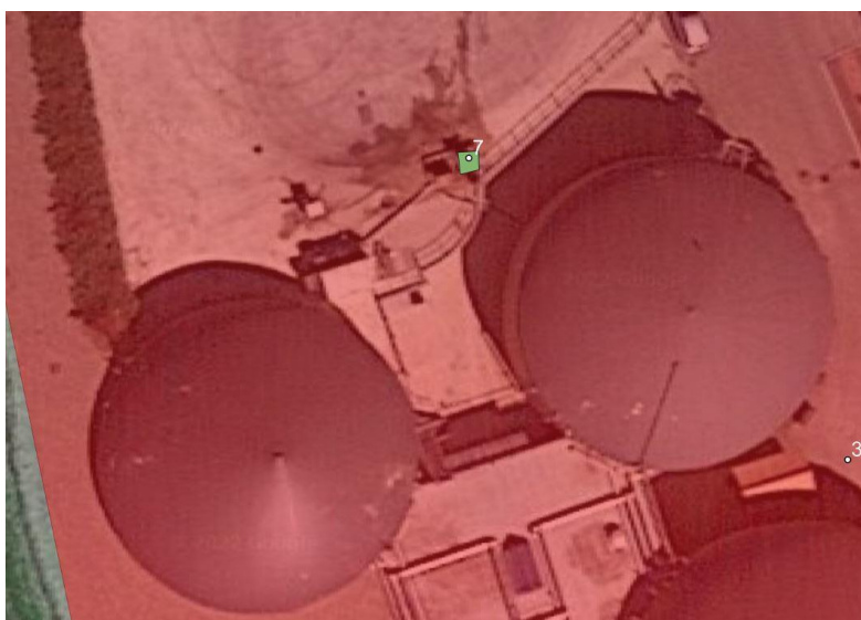
Fig. 4.26 Punto di alimentazione evidenziato in verde
