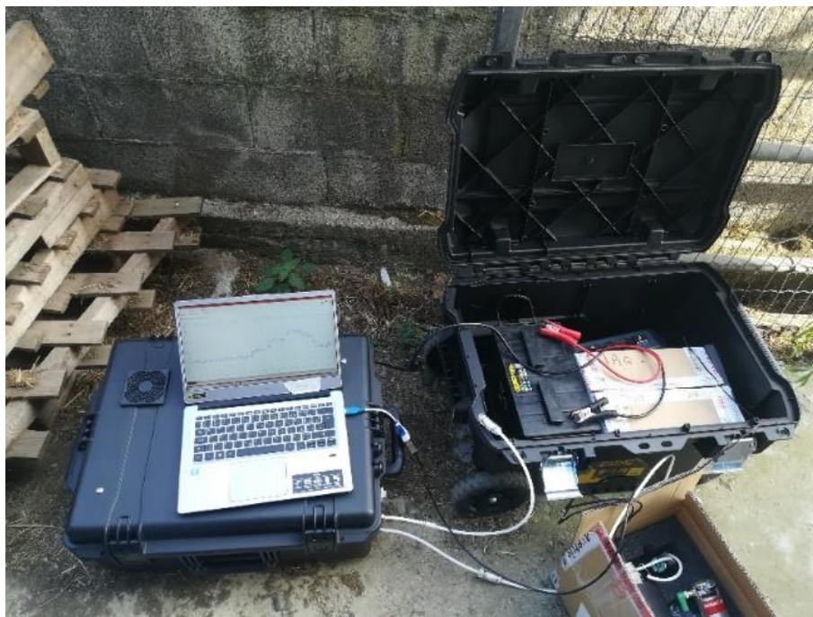
Fig. 4.2 Computer, FTIR, TDLAS e batteria.
